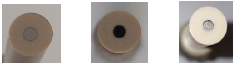
Abbildung 24: Links: Platinelektrode, blank. Mitte: Platinelektrode nach ECP bei 3,5 V für 1000 s (0,02 M JSD919, 0,1 M TBATFB in AN). Rechts: Platinelektrode nach CV von -0,5 V – 3 V für 5 Scans bei 100 mV/s (0,05 M JSD919, 0,1 M TBATFB in PC).
