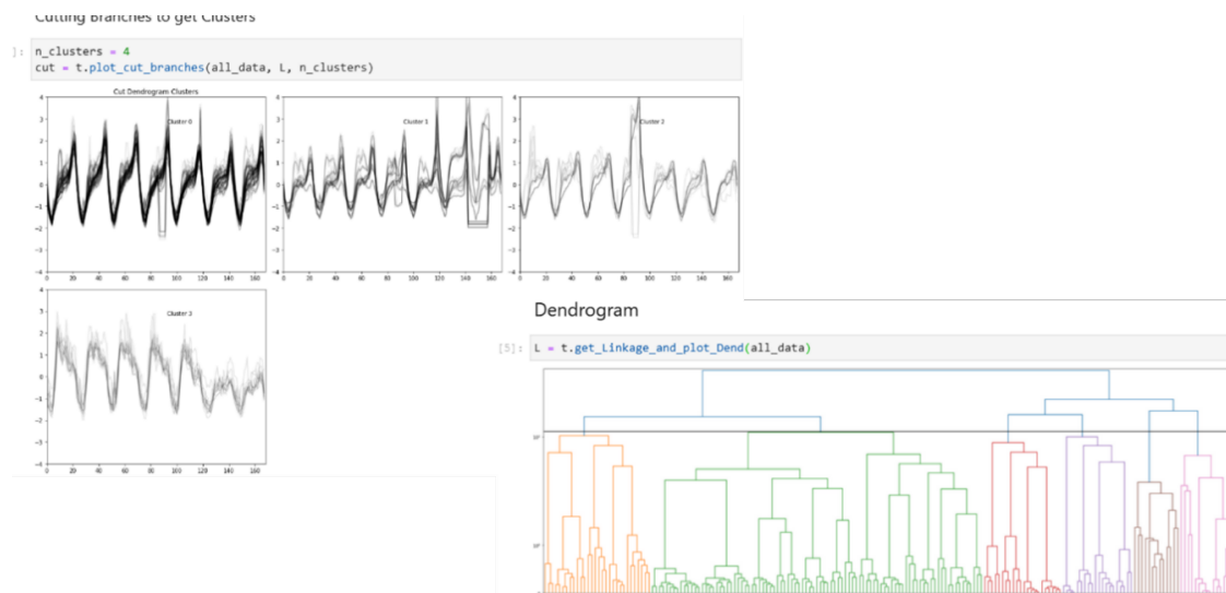
Abbildung 12: Datenverarbeitung auf globaler (Server) Ebene: Einzelne Zeitreihen der gleichen Metrik von verschiedenen Geräten können geclustert werden.
