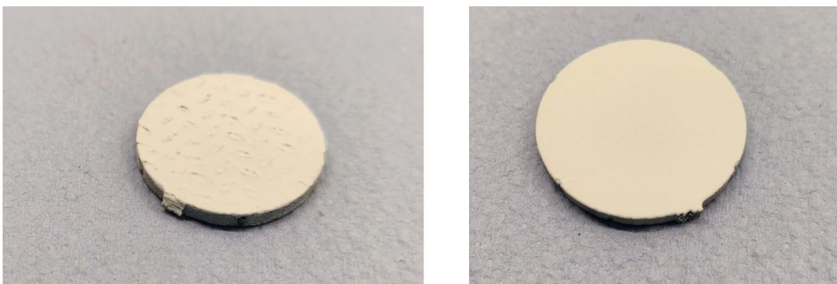
Abbildung 39: Beschichtete Haftzugprobekörper, links: verstärktes Mg AZ91, rechts: unverstärktes Mg AZ91
