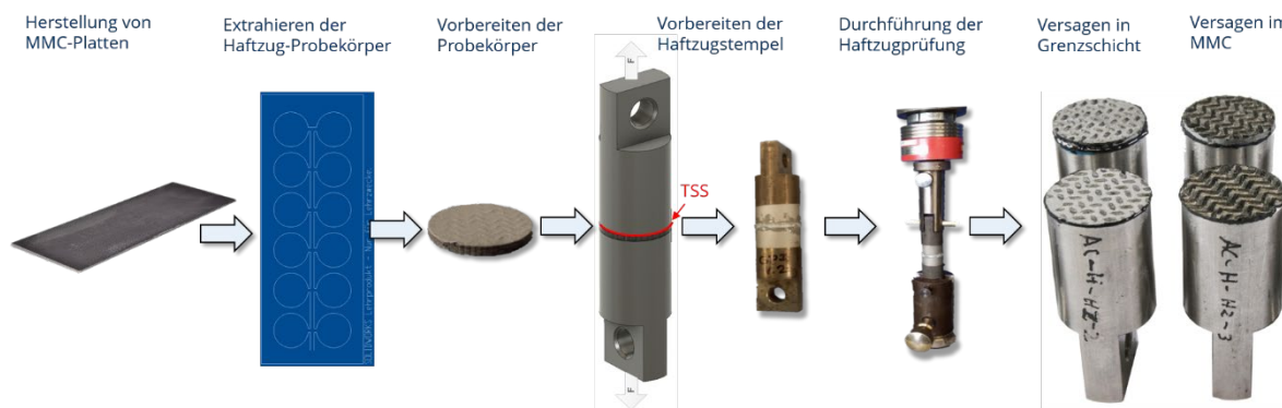
Abbildung 40: Durchgeführte Schritte zur Haftzugprüfung
