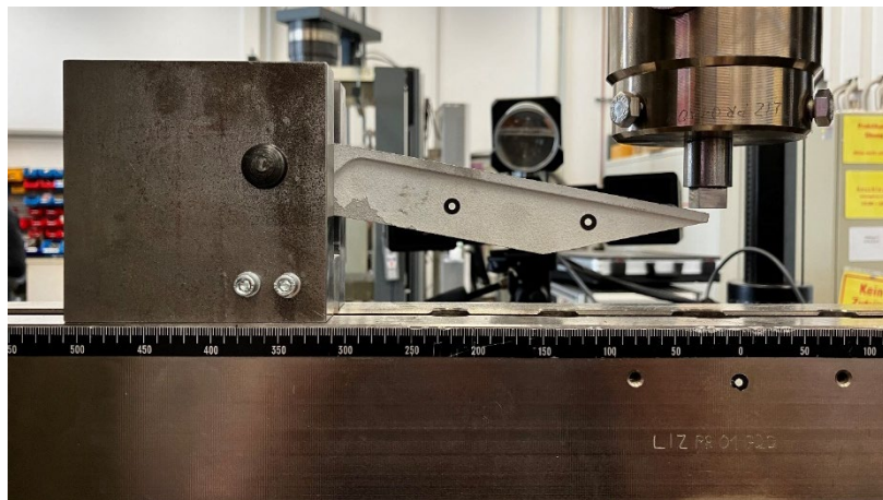
Abbildung 78: Einspannung des Hebels vor (oben) und nach erfolgter Biegeprüfung (unten)
