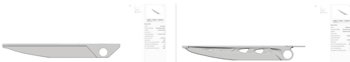
Abbildung 83: Workaround und resultierende Anpassung zum Hebeldesign in Fusion360; links fräsgerecht, rechts topologieoptimiert
