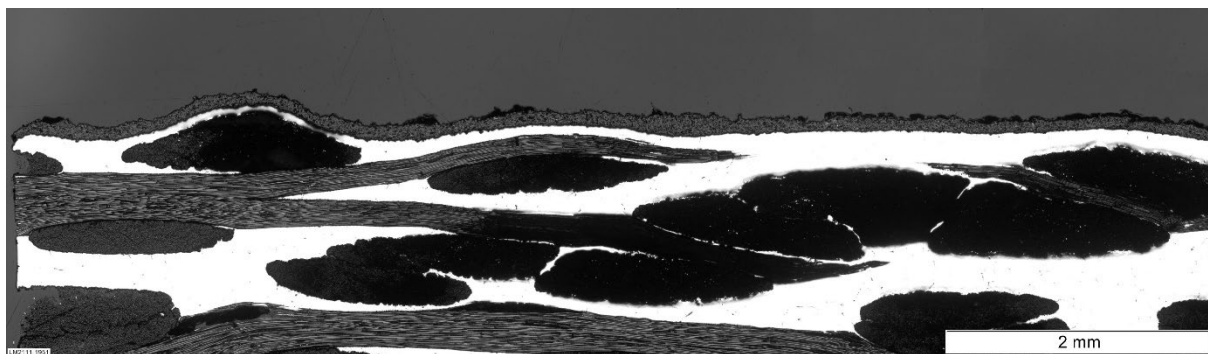
Abbildung 52: \text{Al}_2\text{O}_3\text{-3TiO}_2 -Beschichtung (APS-Prozess)
