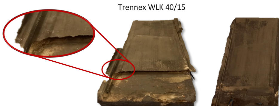
Abbildung 24: Vergleich der Entformungsergebnisse beispielhaft an den Schichten von Trennex
