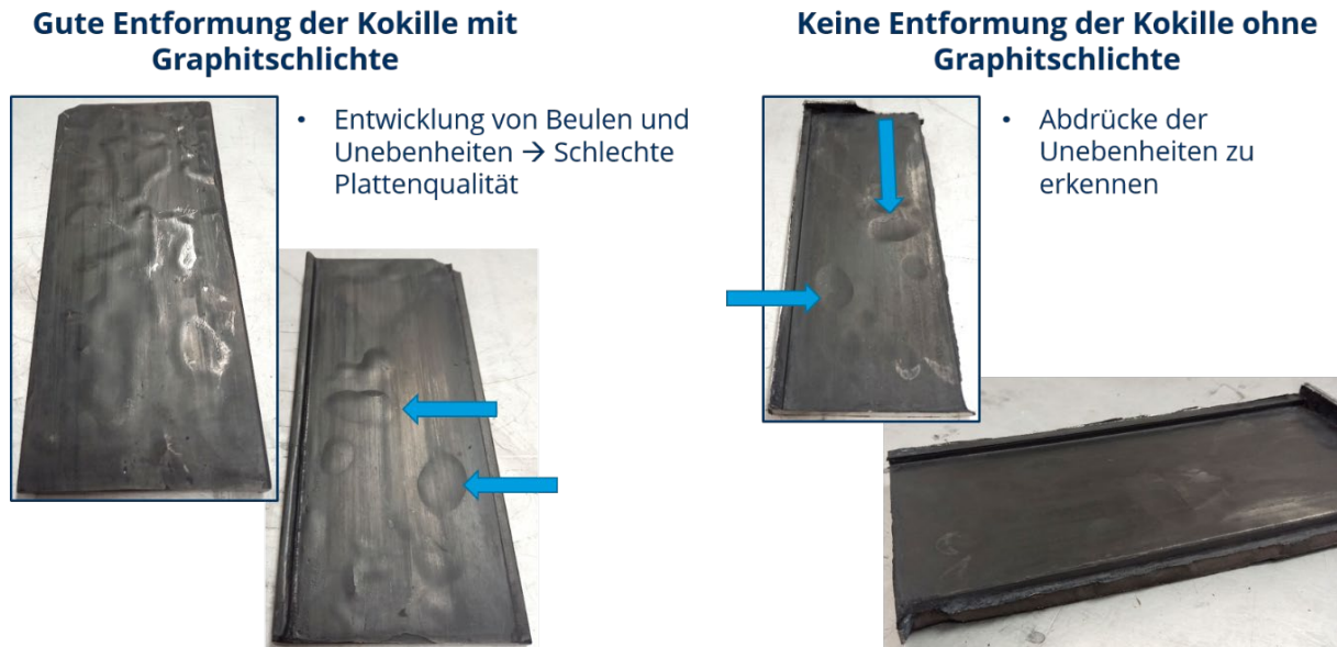
Abbildung 29: Prozesstests der keramisch beschichteten und modifizierten Graphitkokillen im GDI-Verfahren mit verschiedenen Schichteinflüssen
