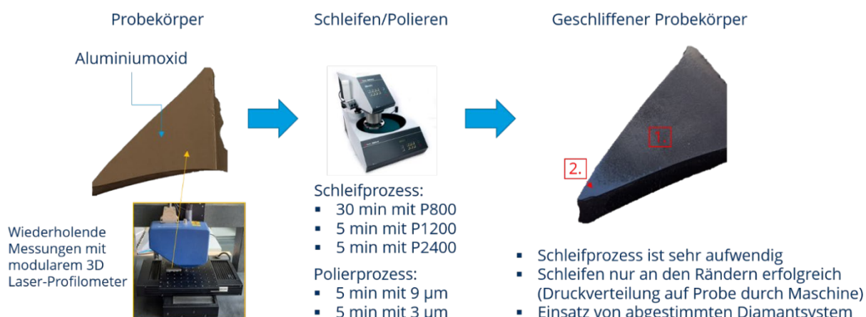
Abbildung 33: Einblick in den erarbeiteten und abgestimmten Präparationsablauf zur nachträglichen Modifikation der Rauheit des auf Graphitkokillen aufgetragenen keramischen Schichtsystems
