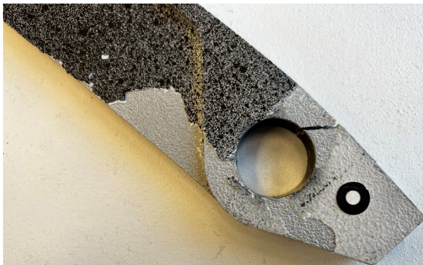
Abbildung 80: Detailansicht des Versagens der Hebelstruktur an der Oberseite des Lagerauges
