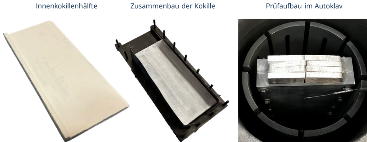
Abbildung 36: Vorbereitungsschritte zur Prüfung des Materials CarSIK-NG auf die Entformbarkeit – Beschichten der Innenkokille (links), Zusammenbau der Innen- und Außenkokille (mittig), Positionieren im Autoklav und Bestückung mit Mg-Material (rechts)
