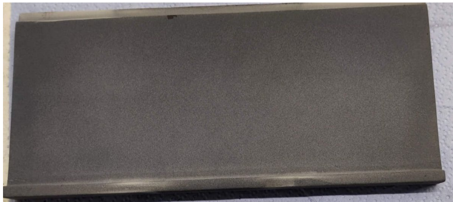
Abbildung 61: Al 2 O 3 /6TiO 2 beschichtete Graphitkokille, hergestellt mit APS
