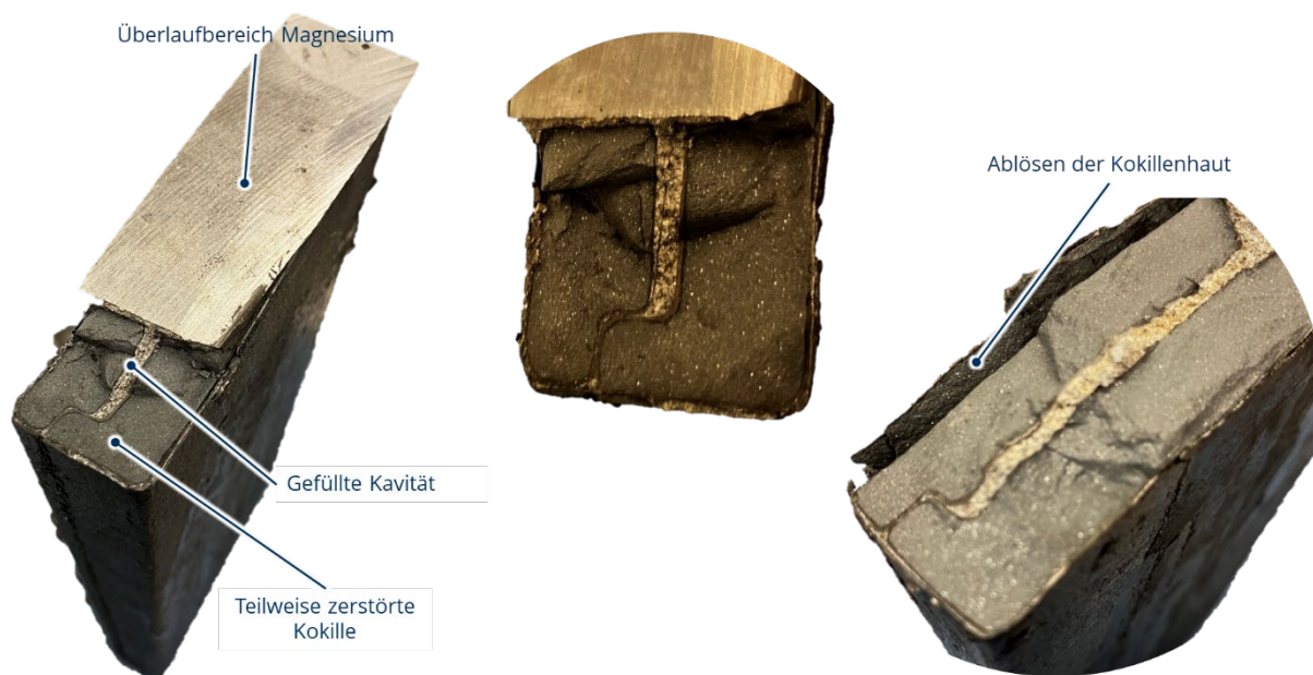
Abbildung 37: Ergebnis des Abgussversuchs der CarSic-Kokillenmaterials - Übersichtsbild der Kokille in Entnahmeposition (links), Detailansicht der Fehlstelle an der Oberseite der Kokille (mittig) und weitere Fehlstellen nach versuchter Entformung (rechts)
