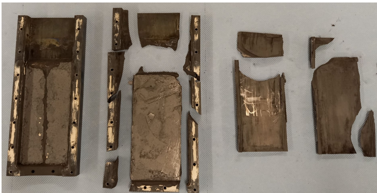
Abbildung 21: Beschädigte Außenkokille und Innenkokille nach dem Einsatz von PL-E 125
