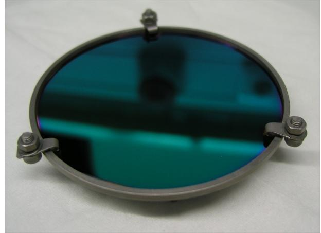
Abbildung 103: Mit  $\text{TiO}_2$  beschichteter Silizium-Wafer zur Bestimmung der Schichtspannung.
