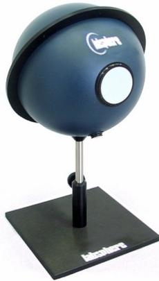
Abbildung 21: Strahldichte-Normal Labsphere USS-800S-035 [21] zur Kalibrierung der spektroskopischen Diagnostiken.
