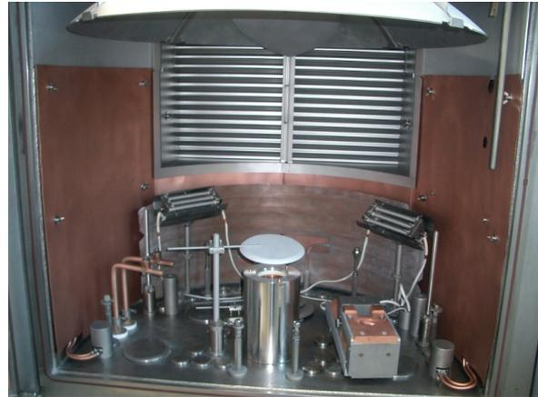
Abbildung 4: Aufbereiteter Rezipient der SYRUS LC-3 mit Plasmaquelle APS, Elektronenstrahlverdampfer und Heizstrahlern; ohne Bodenabdeckung.
