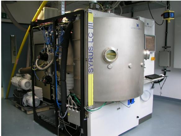
Abbildung 3: PIAD-Anlage SYRUS LC-3 der Leybold Optics GmbH während der Installation am INP.
