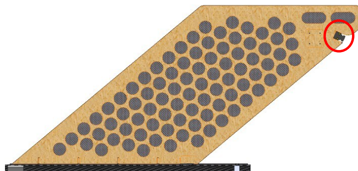
Abbildung 7: Darstellung des MDF-Kerns der Finnen; die dargestellten Aussparungen sollen das Gesamtgewicht der Finnen reduzieren ohne deren Größe zu verringern; rot eingekreist ist die Kamera-Position in den Finnen (siehe II.1.1.6 Nutzlast)
