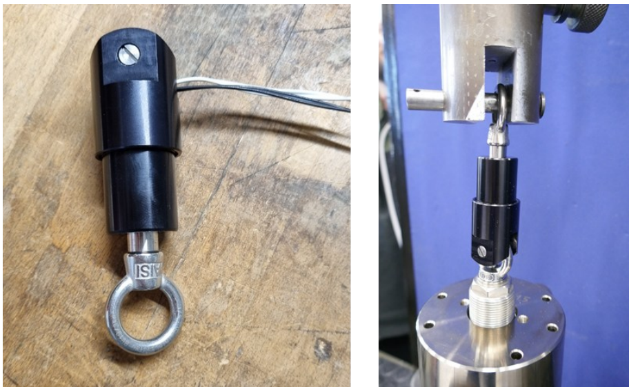
Abbildung 31: Tender-Descender der Firma Tinder Rocketry im zusammengebauten Zustand mit verbauten Pyrozündern (links) und eingebaut in eine Zugprüfmaschine zur Charakterisierung der maximalen Belastung (rechts)
