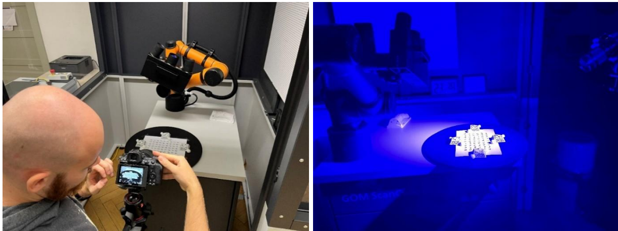
Abbildung 13: Labor-Aufnahmesetup mit Testmuster und (TLRK)-Referenzkörper (Links: 3D Scanner Atos Q und Testset, Rechts: Aufnahme mit forensischer Beleuchtung)
