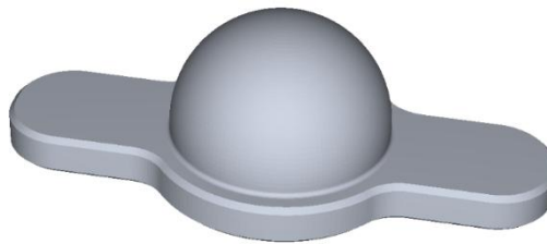
Abbildung 17: CT-Referenzkörper (50mm Länge, Durchmesser des Kugelsegmentes 20mm)
