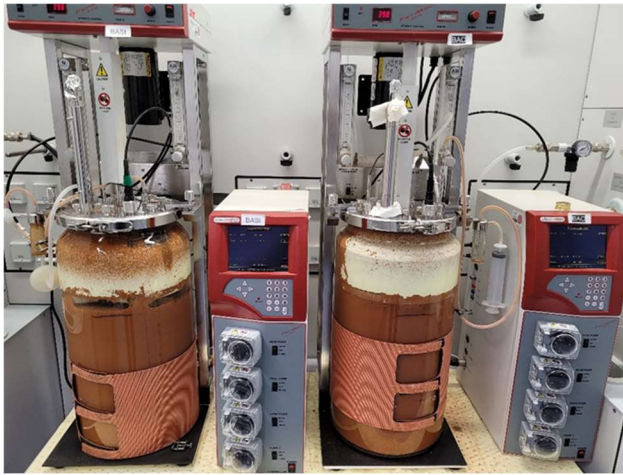
Abb. 6. Biolaugungsversuche in 20 L Bioreaktoren mit Rührwerk unter Zugabe von Elementarschwefel und Lateritz im Geomikrobiologielabor der BGR (Foto: Coverfoto des Sonderheftes „Special Issue on International Biohydrometallurgy Symposium (IBS) 2022“ der Fachzeitschrift „Research in Microbiology“, Vol. 175, No. 1-2, https://www.sciencedirect.com/journal/research-in-microbiology/vol/175/issue/1 ).
