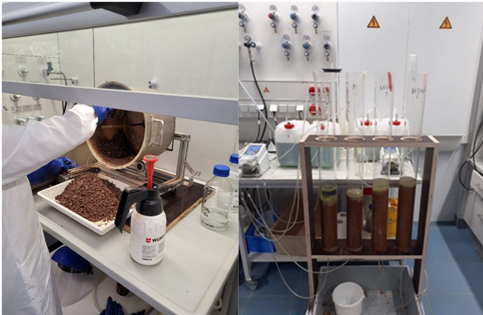
Abb. 10. Agglomeration von feinkörnigem Lateriterz (Probe Piauí I) in einer rotierenden Trommel mit Schwefelsäure (links) und Perkolatoren befüllt mit Agglomeraten für Biolaugungsversuche (rechts) im Geomikrobiologielabor der BGR.
