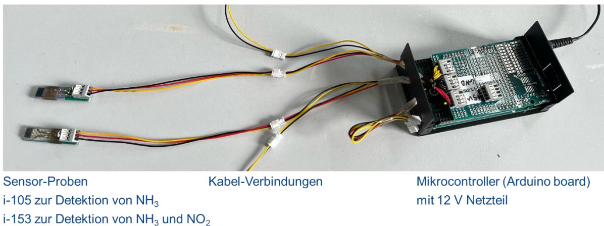
Abbildung 59: An das chinesische Schwesterprojekt verschickte Sensoren für \text{NH}_3 und \text{NO}_2+\text{NH}_3 mit Verkabelung zum Mikrocontroller.
