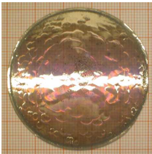
Abb. 8 Wafer mit 180\ \mu\text{m} dicker, rissfreier GaN-Schicht auf Saphir mittels SiN-Punktmaske gewachsen.
