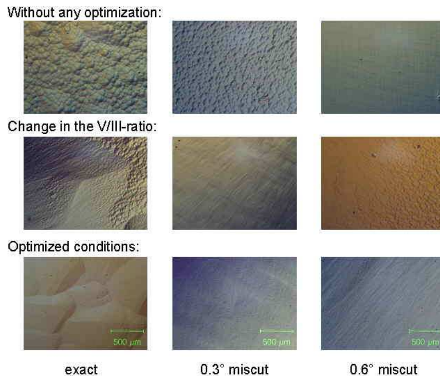
Abb. 1 Nomarski-Kontrast-Mikroskop-Aufnahmen von Oberflächen von GaN-HVPE-Schichten auf unterschiedlich fehlorientierten Saphir-Wafern, die jeweils gleichzeitig in unterschiedlichen Prozessen epitaxiert wurden. Ohne spezielle Maßnahmen am Ende des Prozesses (oberste Bilderreihe), Erhöhung des V/III-Verhältnisses kurz vor Ende des Epitaxieprozesses (mittlere Bilderreihe), Erhöhung des V/III-Verhältnisses und weitere Maßnahmen (unterste Bilderreihe).
