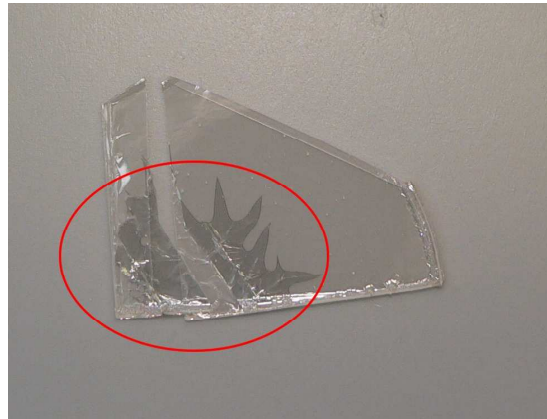
Abb. 12 Foto eines dick überwachsenen Templates mit SiN-Zwischenschicht. Im markierten Bereich ist bereits eine teilweise Ablösung der gewachsenen Schicht zu beobachten.
