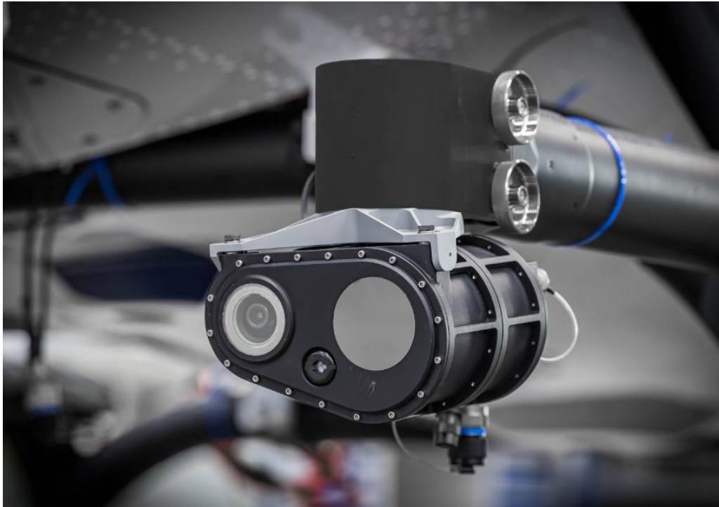
Abbildung 6: Eine montierte Front Sector Kamerabox am Landegestell des H145 PioneerLab Versuchsträgers des Partners AHD.
