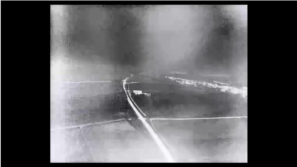
Abbildung 26: Aufnahme des LWIR-Kanals der Front Sector Kamerabox während eines Durchfluges eines Regengebietes. Der Kanal ist durch Wassertropfen auf den Germanium-Schutzglas stark beeinträchtigt.
