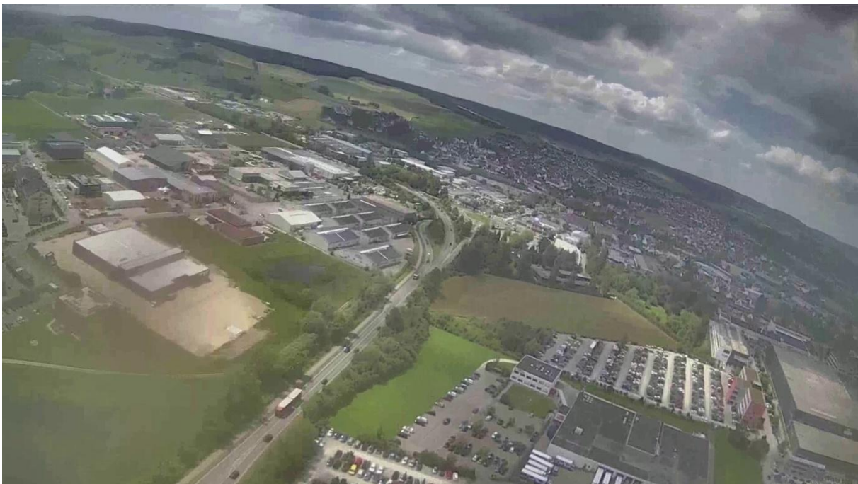
Abbildung 20: Beispielbild aus den Boreighting-Flug. Der Beschlag am Schutzfenster des VIS-Kanals ist deutlich im linken Bereich durch die Bildunschärfe zu sehen.
