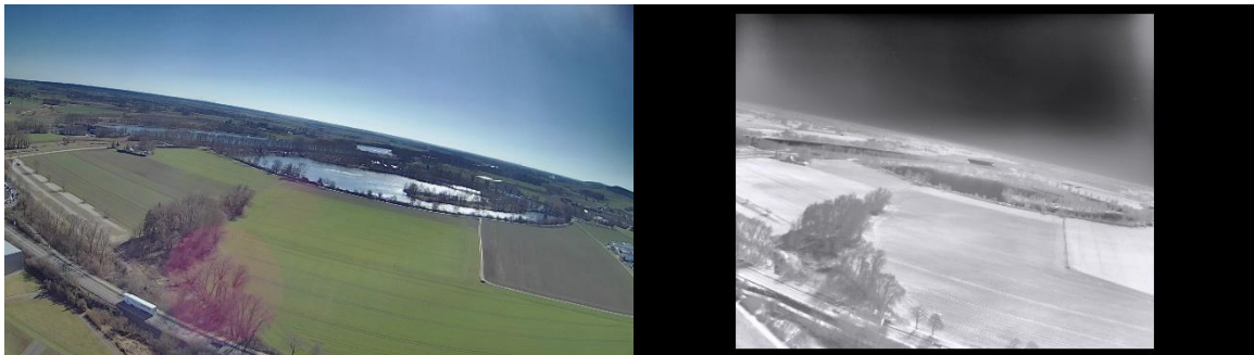
Abbildung 24: Links: Beispielbild des VIS-Kanal der Front Sector Kamerabox. Rechts: Beispielbild und LWIR-Kanals der Front Sector Kamerabox.
