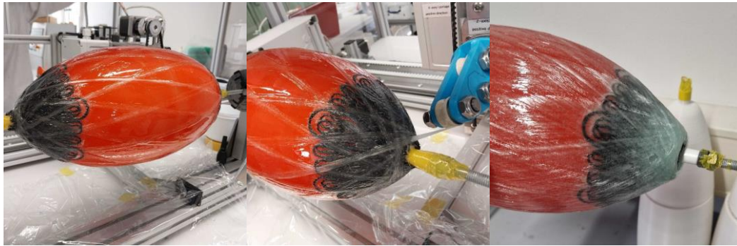
Abbildung 39: Nasswickelprozess zur Applikation des TFP-Patches auf die Endkappe.
