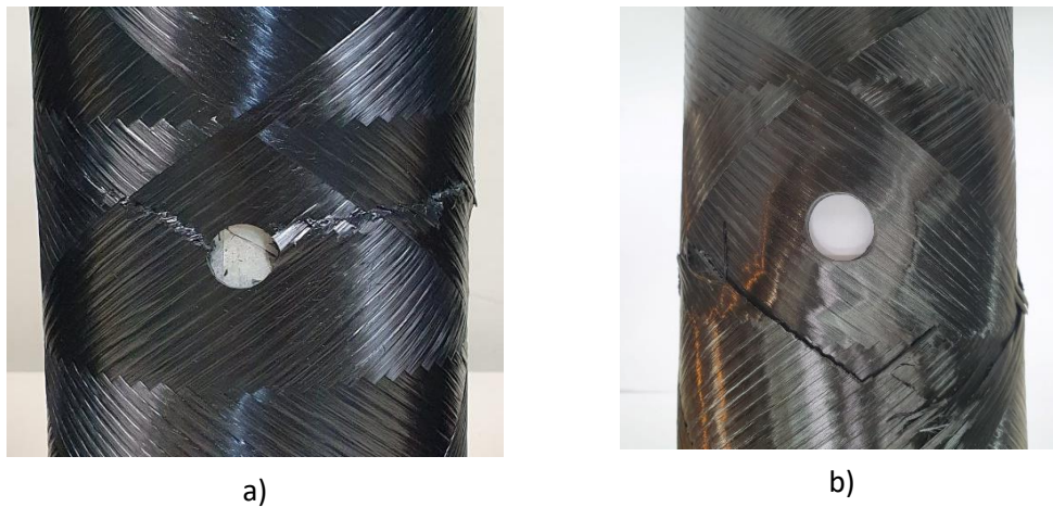
Abbildung 2: a) Bruchbild eines Zylinders ohne Verstärkung (Probe 2) und b) eines verstärkten Zylinders (Probe 3).
