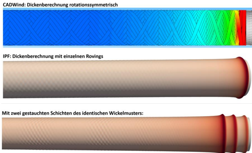
Abbildung 23: Vergleich der Dickenberechnungen von CADWIND® und IPF-Algorithmus.
