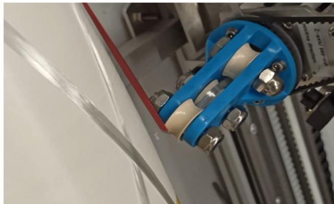
Abbildung 30: Zu Beginn der Entwicklung verlief der Roving die Spule am Ablagekopf nicht zentriert, sondern lief seitlich von der letzten Umlenkrolle ab (rot hervorgehoben). Dieses Problem konnte im weiteren Verlauf der Entwicklung behoben werden, so dass Prozesssimulation und Ablageverhalten an der Anlage übereinstimmten (siehe auch Abb. 33).
