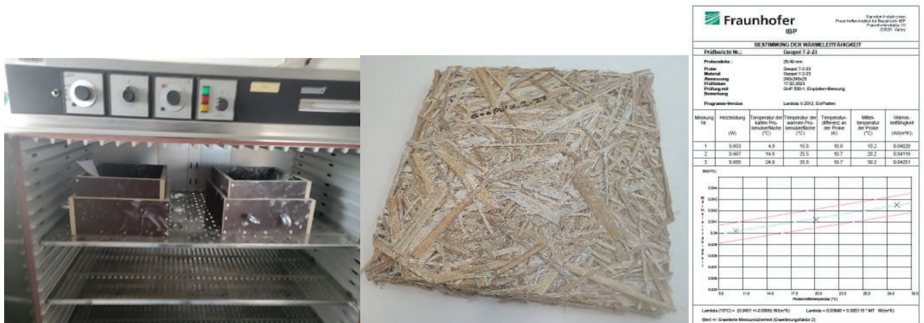
Bild 2: Aushärtung im Heizschrank/ausgeschaltete Probe/Protokoll der Wärmeleitfähigkeitsmessung.
