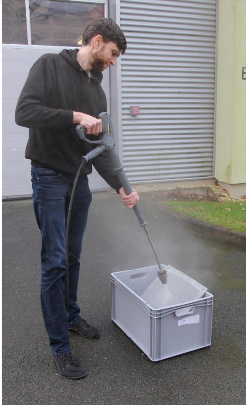
Abbildung 10: links: Versuch zum Entfernen der Beschichtung mit Wasserstrahl; rechts Probenbleche vor (oben) bzw. nach (unten) dem Kärchern.
