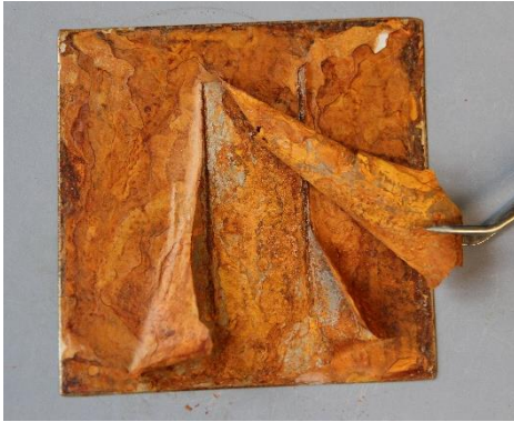
Abbildung 9: Entfernen der Beschichtung von korrodiertes T03-Probekörper.
