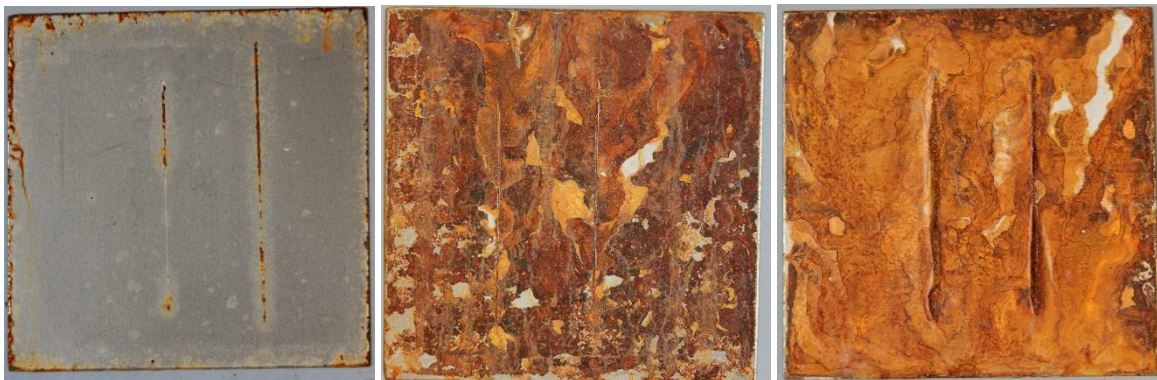
Abbildung 8: Neutraler Salzsprühtest an beschichteten Blechen nach 24 h; li. Paraloid B72; mi. StM T02/CAB 4/1 + 5% Aerosil 200; re. StM T03/CAB 4/1 + 5% Aerosil 200.
