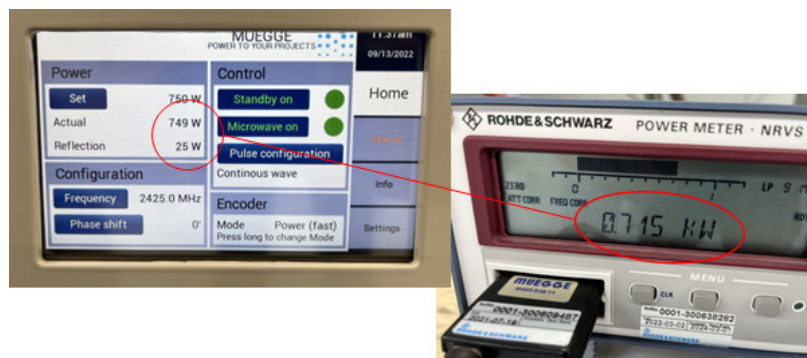
Abb. 8: Bedienpanel des Prototyps des Mikrowellenhalbleiternetzteils während der Tests zur Messung der maximal möglichen Mikrowellenausgangsleistung und der dabei gemessenen reflektierten Mikrowellenleistung.
