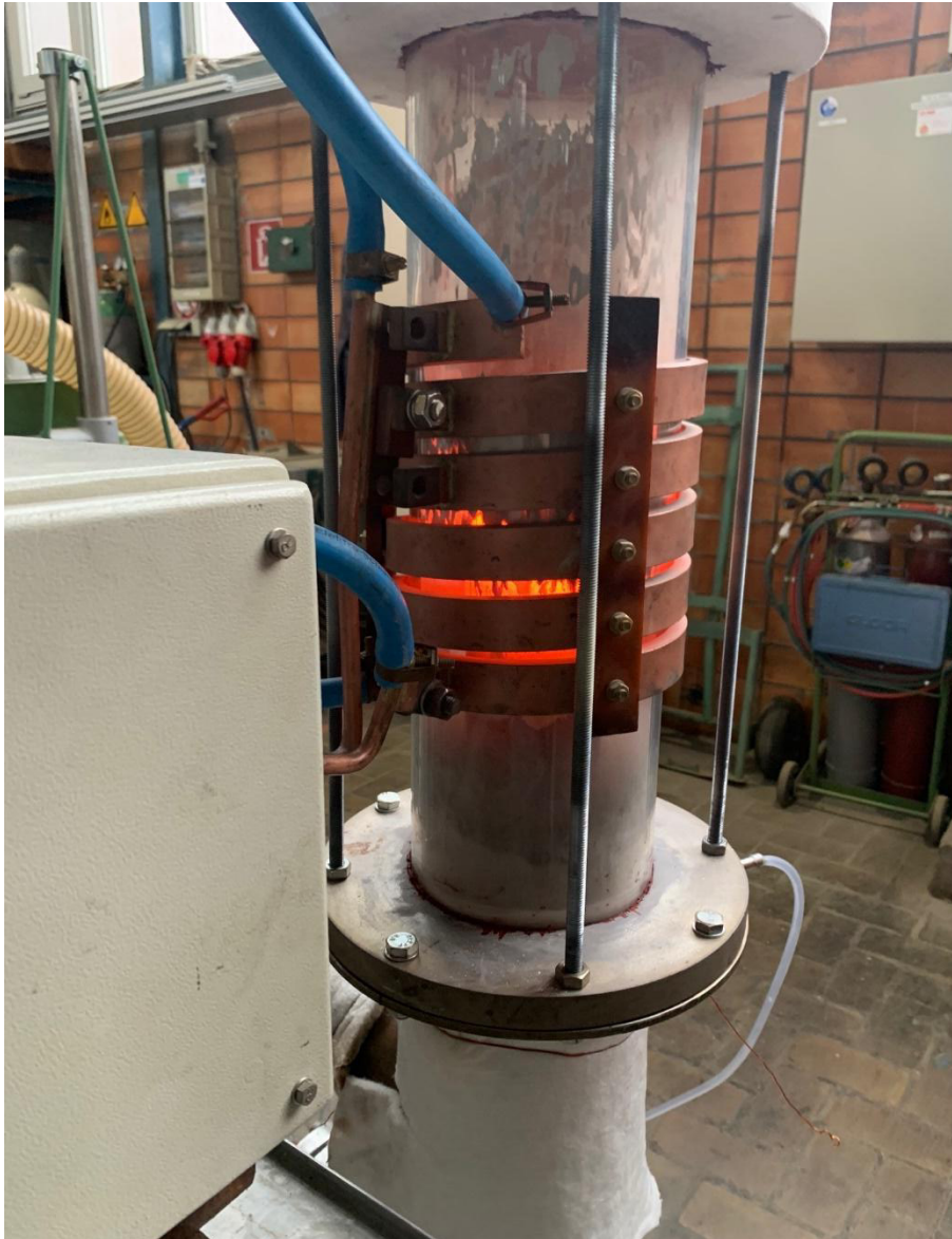
Abb. 14 Wirbelschichtanlage, welche für die Calcinierung der Tone verwendet wurde.
