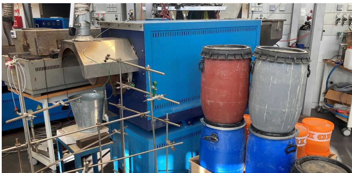
Abb. 10 Drehrohrfurnen, der für die Calciniertemperatur der Tone in diesem Projekt genutzt wurde.
