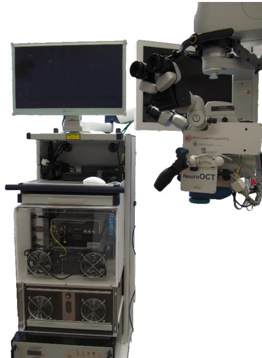
Abbildung 29 Gesamtsystem „Neuo-OCT“ mit dem Bedien- und Darstellungs- Rack (links), sowie der an den OP-Mikroskop-Kopf adaptierten „nOCT Box“.
