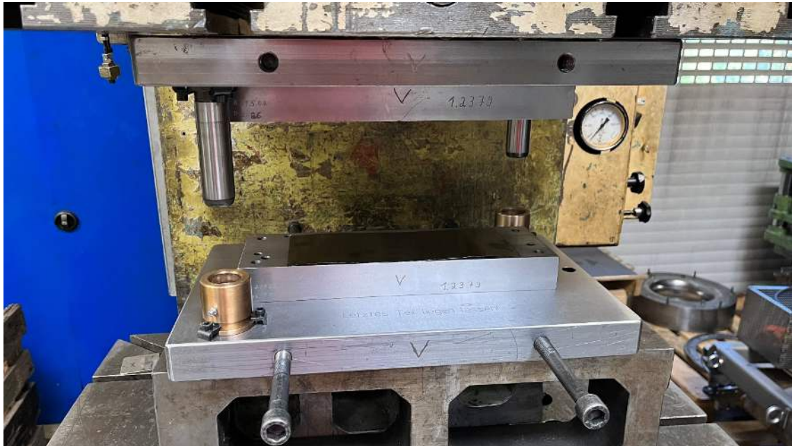
Abbildung 6: Säulengestell mit Tiefziehgesenken in Hydraulikpresse
