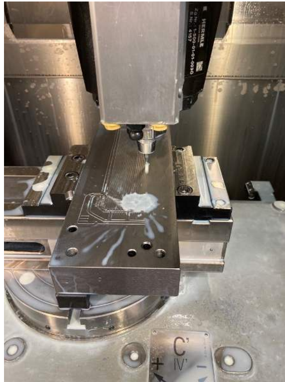
Abbildung 5: Herstellung der Tiefziehgesenke
