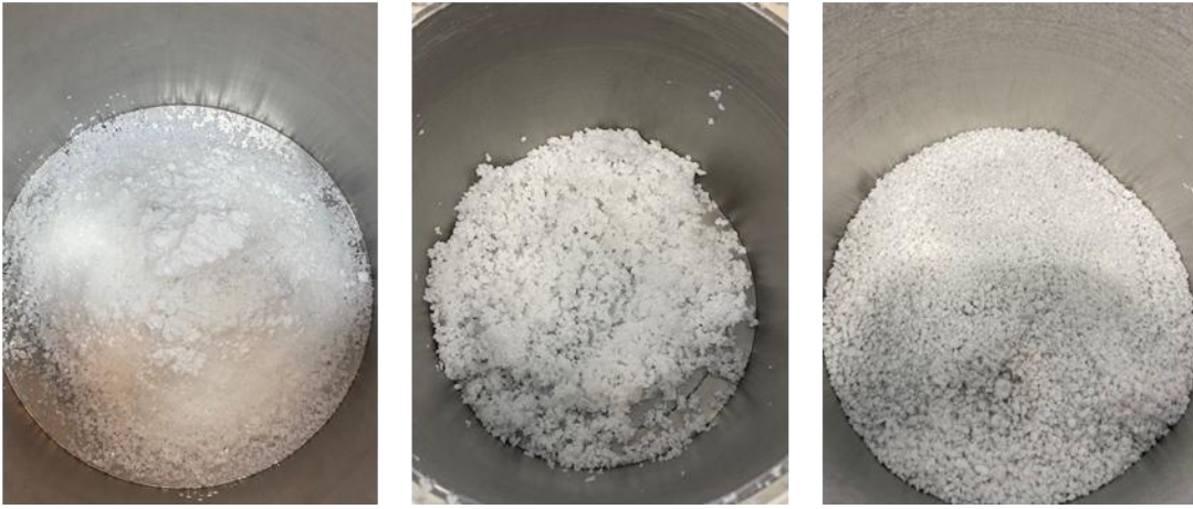
Abbildung 2: Materialaufbereitung v.l.n.r: Vor der Aufbereitung, während der Aufbereitung, nach der Granulierung
