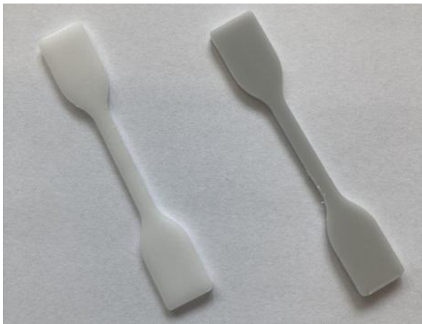
Abbildung 3: Spritzgegossene Proben: reines PCL (links), Komposit mit 30 Gew.-% bioaktivem Glas (rechts)
