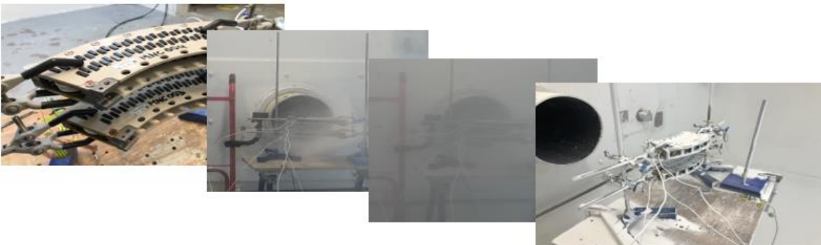
11: Tests der Phaseneinheit in abrasiver Umgebung (Sand & dust)
