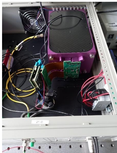
Bild 13 Spektrometereinschub mit integrierter Solectrix-Elektronik
