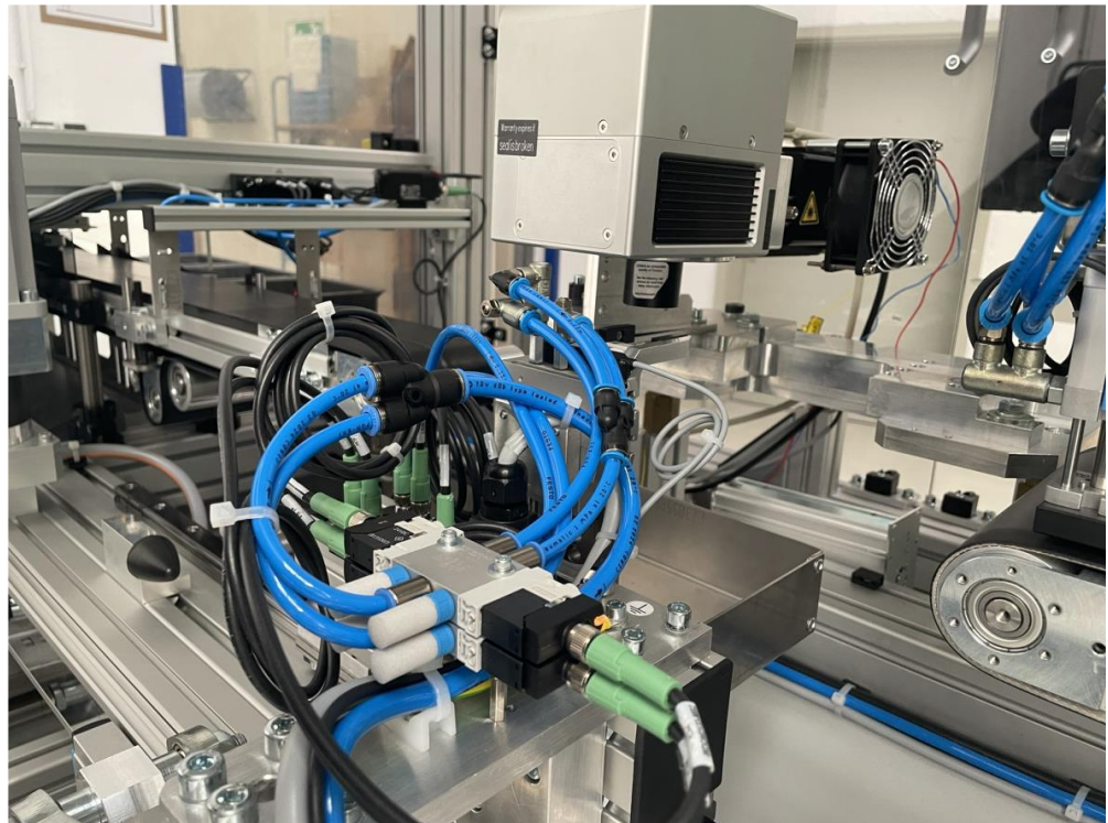
Bild 20 – Integrierter QUIN-Sensor in der 3D-Inspektionsanlage im Technikum des Projektpartners Nela
