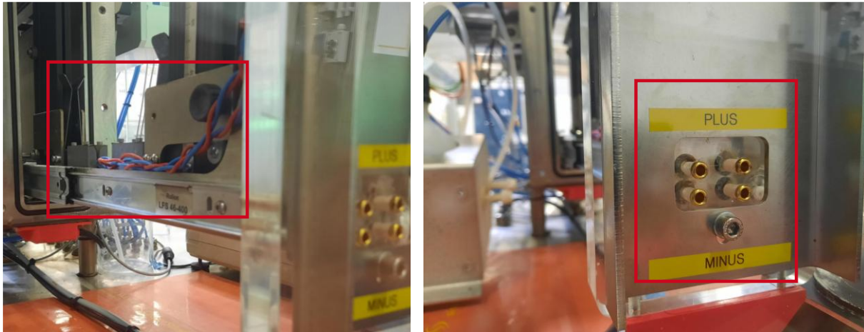
Abbildung 3: Einbau und Anbindung der Kontaktblöcke (links) und Durchführung der Verkabelung nach außen (rechts)
