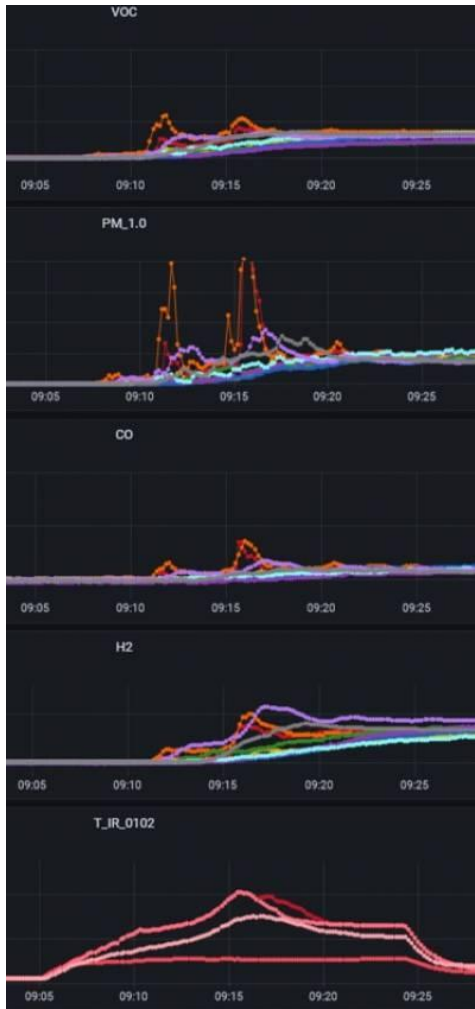
Abbildung 28: Signalverlauf während des Kabel-Schmelbrandversuches „E2“ am 7. 7. – gezeigt ist beispielhaft nur eine Auswahl relevanter Signale
