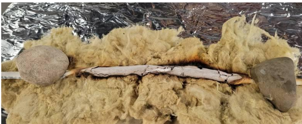
Abbildung 27: Foto des Kabelschmelbrandversuches nach Versuchsende: Zu erkennen ist die verschmolzene elektrische Isolierung des Kabels. Die Steinwolle im Untergrund dient der mechanischen Stabilisierung und der thermisch stabilen elektrischen Isolation nach unten.
