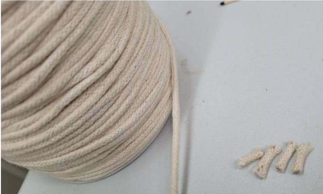
Abbildung 16: Kleinskalige Experimente in der Kammer: Brandlast „Lunte“ aus Baumwolle (Quelle: Projekt-Partner Hekatron); in Längen von je 1 cm
