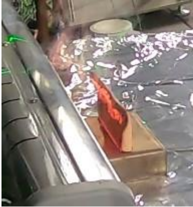
Abbildung 23: Foto des Holz-Schwelbrandversuches – bei Fortschritt „Glimmen“
