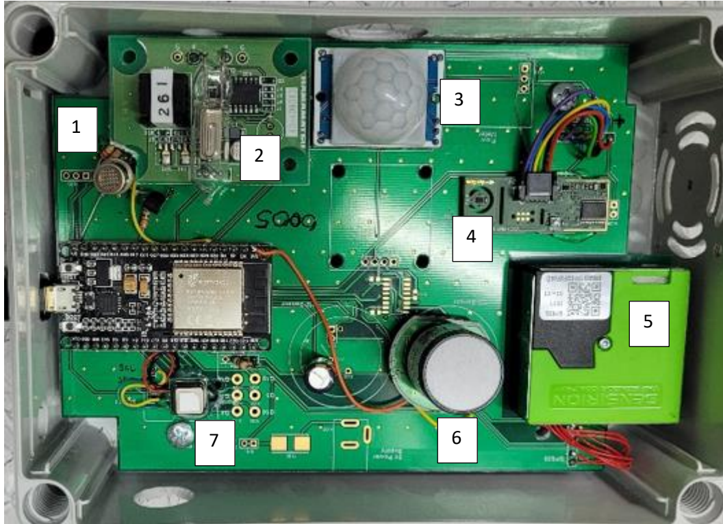
Abbildung 5: Sensorknoten der ersten Generation: Trägerplatine mit ESP32 und den verschiedenen Sensoren in einem Kunststoff-Gehäuse (es verbleibt im Betrieb offen!)
