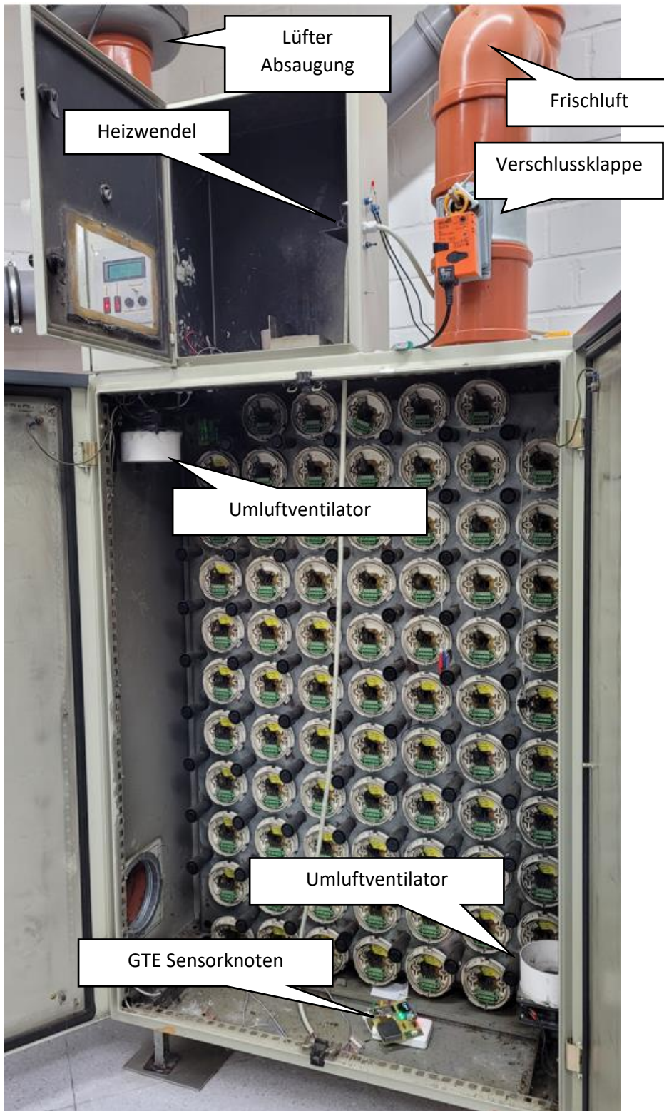
Abbildung 10: Testschrank (Nummer 2) der GTE für kleinskalige Brandtests; die Türen sind für das Foto geöffnet; Volumen 1 m 3
