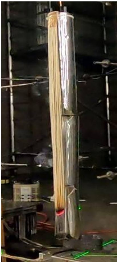
Abbildung 25: Foto des Lunten-Schwelbrandversuches.
