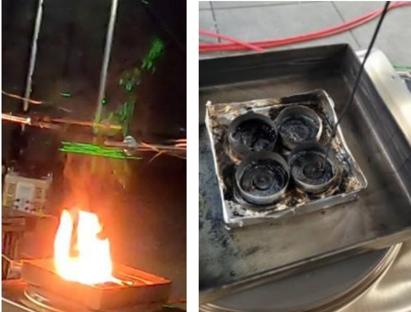
Abbildung 29: Fotos des Kerzen Brandversuches, links während der Phase „Flamme“, rechts nach Versuchsende: Zu erkennen ist zunächst die Entflammung des heißen Wachses. Das rechte Bild zeigt die Reste der Alu-Teelichtergefäße in der Versuchswanne.
