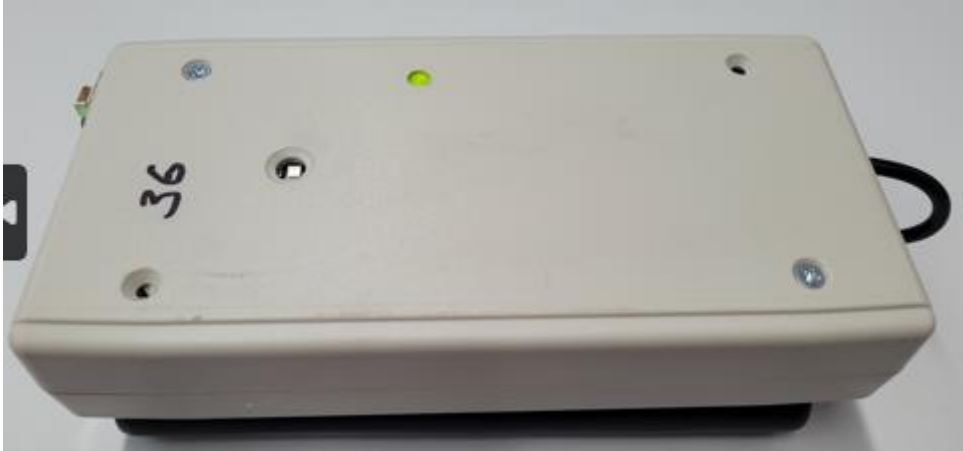
Abbildung 7: Sensorknoten der dritten Generation: ESP32 und verschiedenen Sensoren in einem Kunststoff-Gehäuse mit interner WLAN Antenne.
