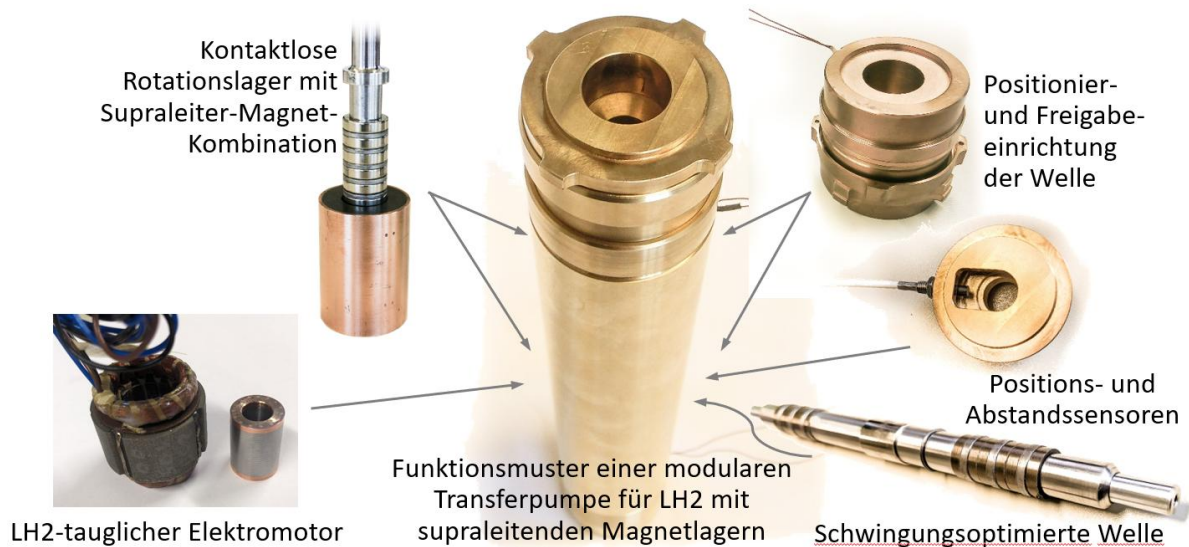
Abbildung 1: Einige der wesentlichen Komponenten des Pumpen-Funktionsmusters
