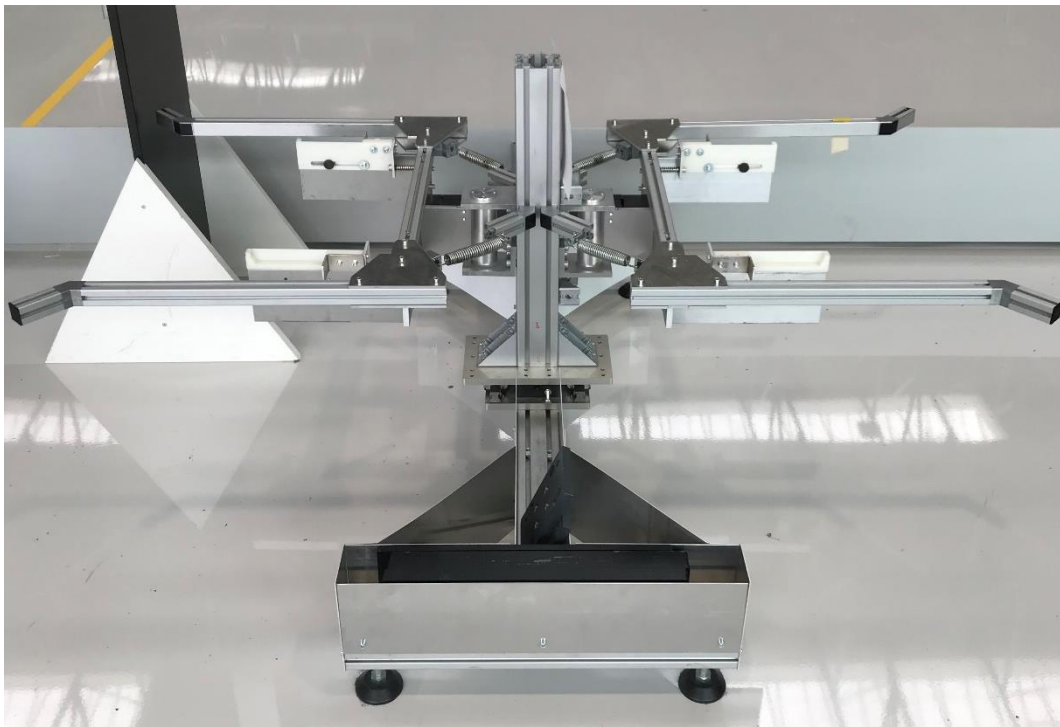
Abbildung 34: Ablagestation für SAM-Beine umgesetzt (oben: frontal, unten: seitlich)
