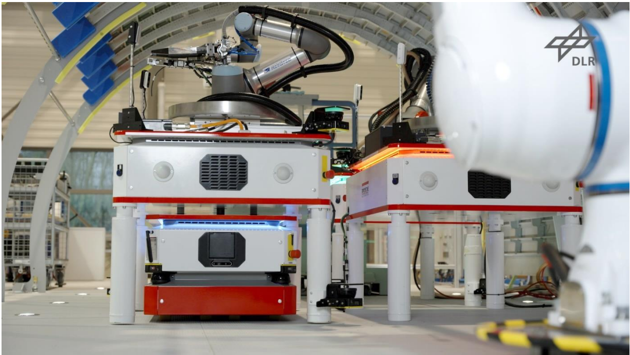
Abbildung 40 Autark arbeitende Leichtbaurobotereinheit von Broetje Automation zum Einsatz in der Flugzeugfertigung
