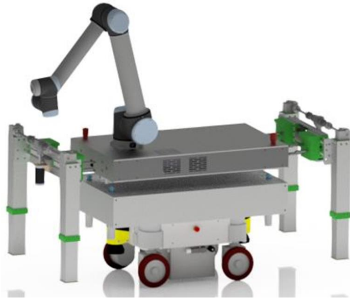
Abbildung 35: Robotermodul geplant (oben), AGV mit Lift (unten), SAM-Beine (seitlich)
