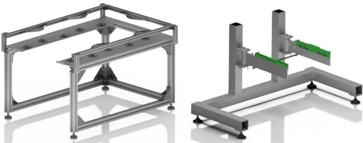
Abbildung 32: Ablagestationen geplant (Arbeitsmodul links, SAM rechts)
