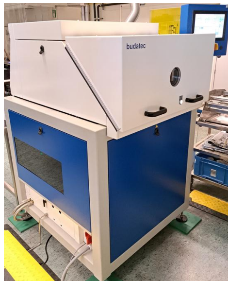
Abb. 6 Verwendete Sinteranlage zur Herstellung der NTV-Verbindung
