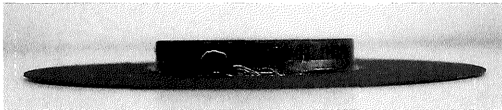
Abbildung 19: nicht verdrillte Flanschfläche beim Blutpumpendeckel aus Gewebe
