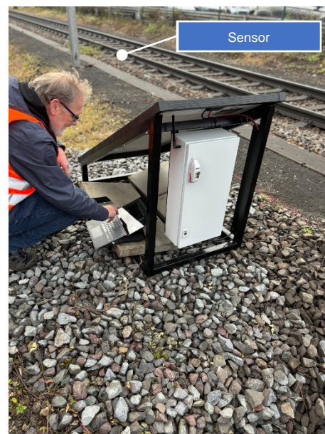
Abbildung 19: Schall-Sensorik-Box Vorderansicht mit Kontrollschrank
