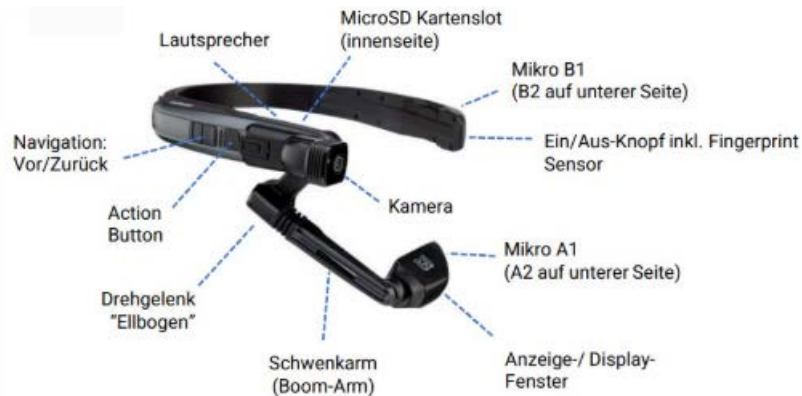
Abbildung 13: Datenbrille "Realware HMT-1" mit Beschriftung (durch leogistics)
