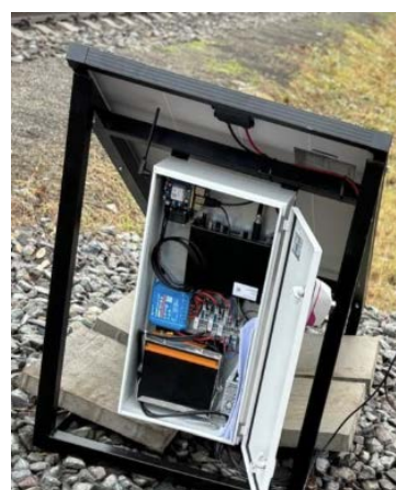
Abbildung 19: Schall-Sensorik-Box Vorderansicht mit Kontrollschrank
