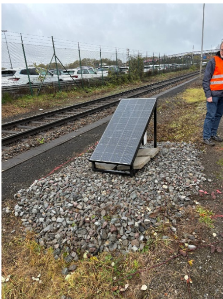
Abbildung 18: Schall-Sensorik-Box Rückansicht mit Solarpanel
