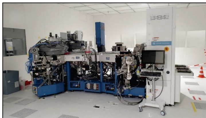
Abbildung 3: 300mm PVD Sputteranlage von AppliedMaterials für modernste Dünnfilmabscheidung
