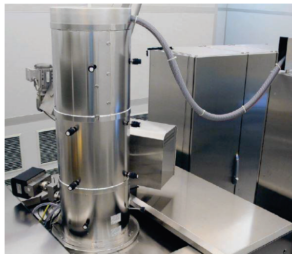
Abbildung 13: VISTEC Elektronenstrahlschreiber am Fraunhofer IPMS-CNT
