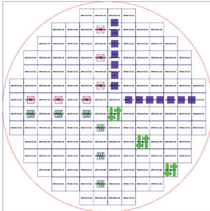
Abbildung 14: Job deck der MatQ Resonator Teststrukturen für die E-Beam Lithographie.
