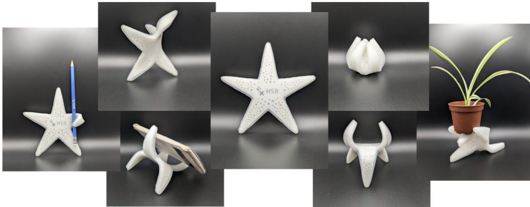
Abbildung 4: Illustration der Anwendungsbereiche der ersten Prototypen einer seestern-inspirierten „morphing structure“. Die Steifigkeit des internen PLA-Gitters kann durch entsprechende Wahl der Druck-Geometrie und Parameter gezielt eingestellt werden. In den ersten Prototypen ist nach einer Erwärmung der Struktur eine gezielte und bleibende Verformung möglich. Durch erneutes Erwärmen nimmt die Struktur ihre ursprüngliche Form (Mitte) wieder an.
