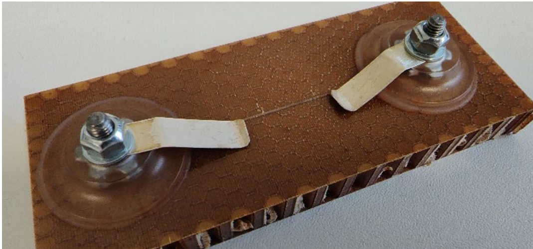
Abbildung 9: Kontaktierung eines Charakterisierungsmusters mittels „Leitungsbrücke“ mit ONSERT®-Technologie
