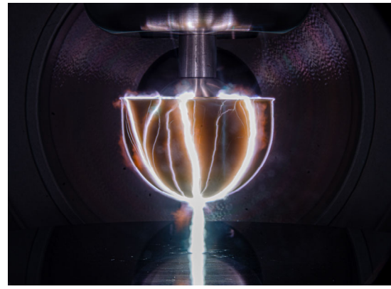
b) Entladung beim Spannungszusammenbruch der hybriden Isolieranordnung [Gam24]
