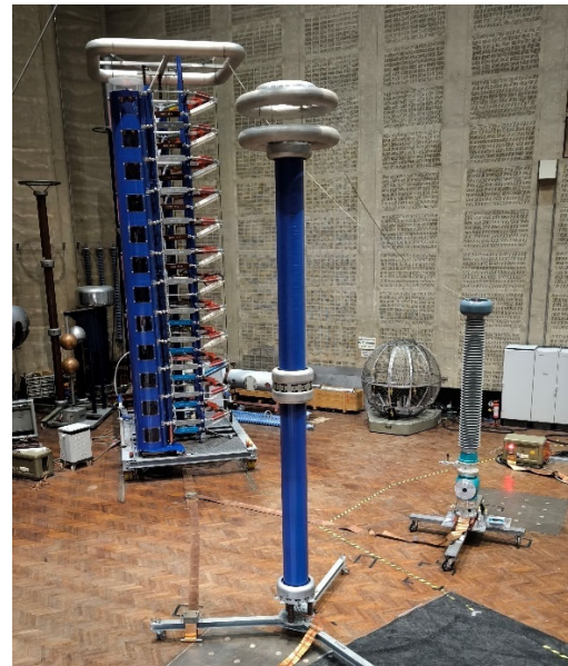
b) Prüfaufbau für Stoßspannungen
