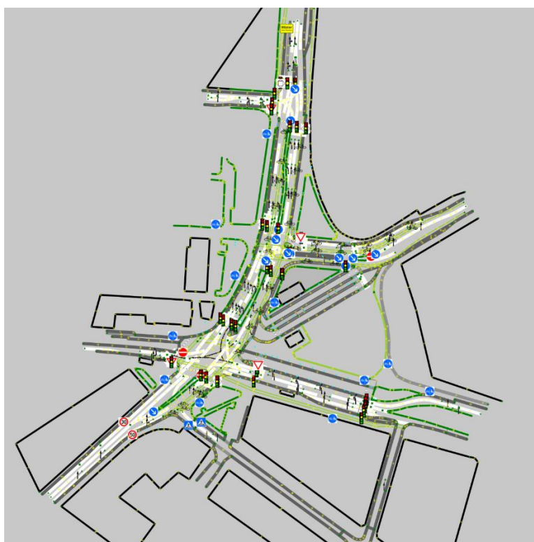
Abbildung 1: Semantische Visualisierung der kartierten Objekte: Zylindrische Elemente wie Pfosten (türkis) wurden parametrisch mit 3D-Informationen erfasst und bilden die Grundlage für die spätere Generierung der Lanelet2-Karte.
