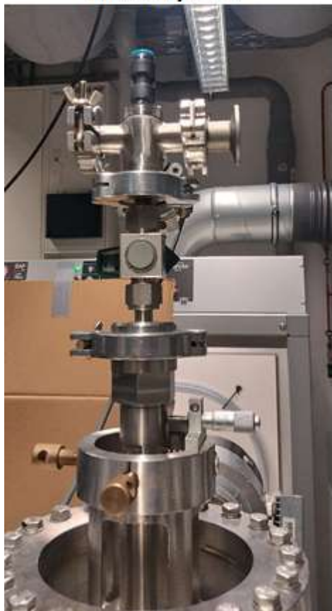
Einlass mit Aerodynamischem Linsensystem
