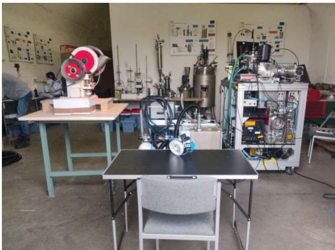
Abbildung 11 Experimentelle Aufbauten im ehemaligen Drogenlabor: Das SPMS-System mit Desorptionsprobenahme und Anreicherungseinheit zur Partikelanalyse von desorbierten Partikeln von Oberflächen sowie die Tablettiermaschine (links) zur Untersuchung von Staubemissionen.
