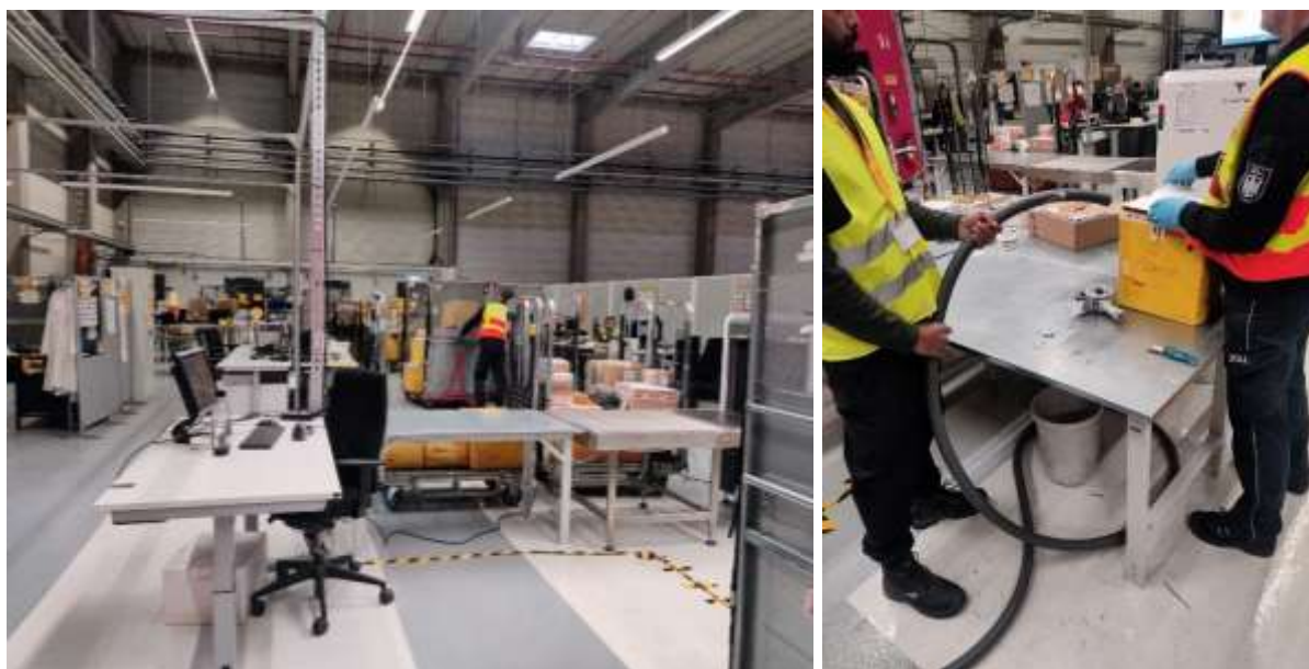
Abbildung 10 Einsatz des SPMS-Systems im DHL-Hub: Erfolgreiche Analyse von Partikeln aus über 400 Sendungen, mit zuverlässiger Detektion von Substanzen wie Kokain und Ketamin unter realen Bedingungen, ohne falsch-positive Ergebnisse.
