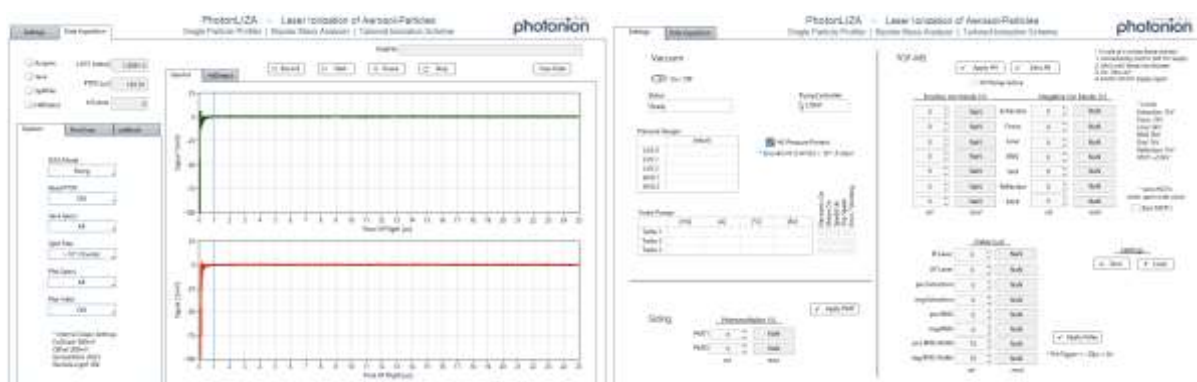
Abbildung 4 Steuersoftware in LabVIEW™: Modulare Integration von Hardwarekomponenten und automatisierte Datenanalyse für präzise Echtzeitkontrolle.
