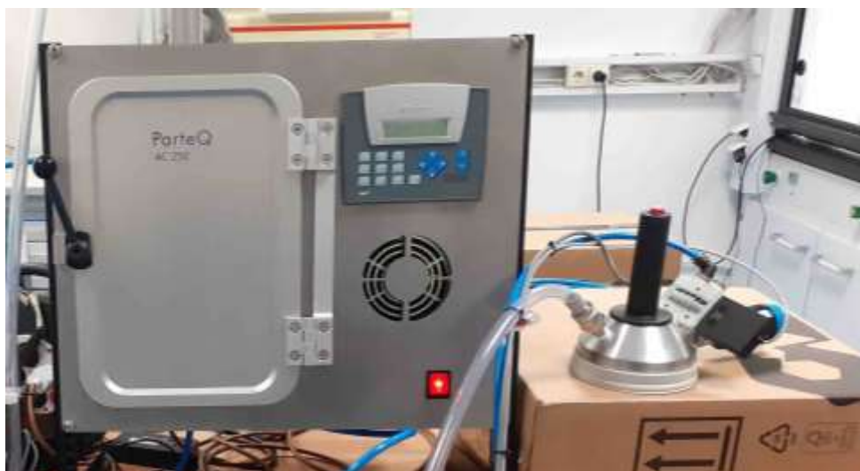
Abbildung 7 Probennahmesystem des Projecktpartners ParteQ bestehend aus der Desorptionseinheit und der Partikelanreicherung
