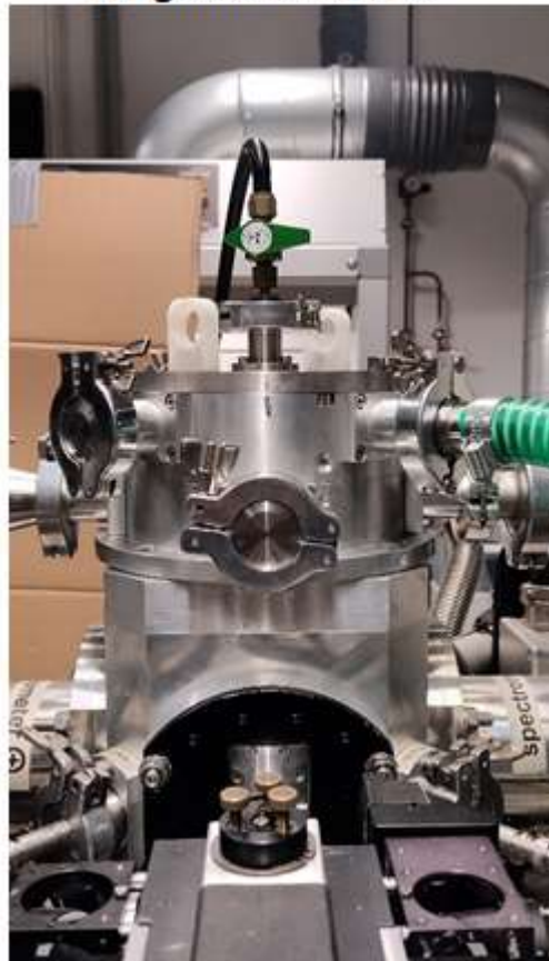
Einlass mit Düse- Skimmer Kombination für größere Partikel
