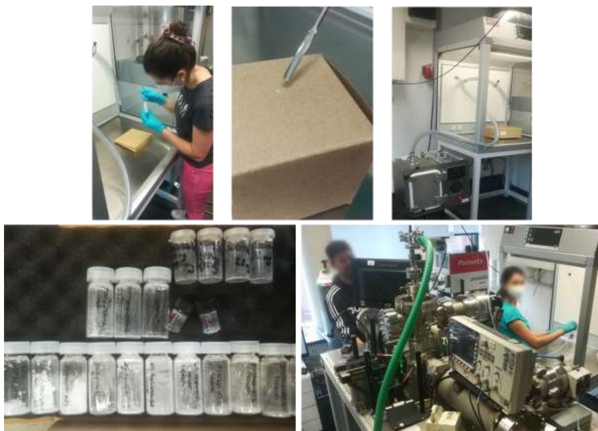
Abbildung 8 Experimenteller Aufbau an der Uni Rostock für die Laborversuche mit Drogenstäuben. Gefahrstoffarbeitsplatz und SPMS-System sind erkennbar.
