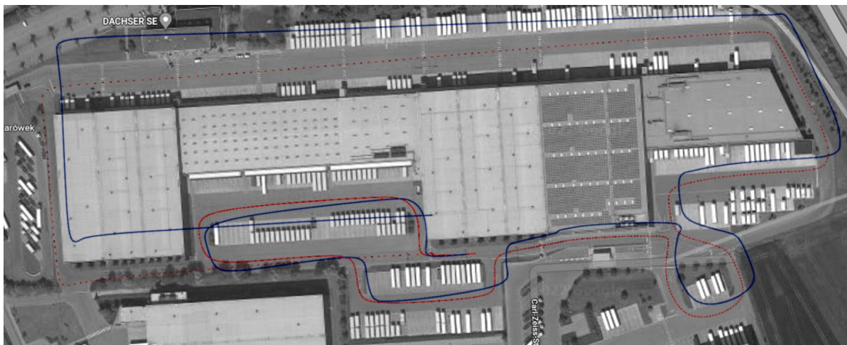
Abbildung 30: Ergebnis der Lidarodometrie (blau) berechnet für die Messdaten einer simulierten Fahrt (rot)
