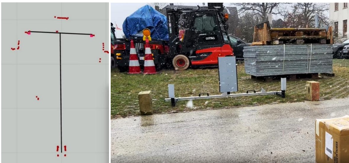
Abbildung 5: Erkennung von geometrischen Ausprägungen aus Scanpunkten bei Schneefall
