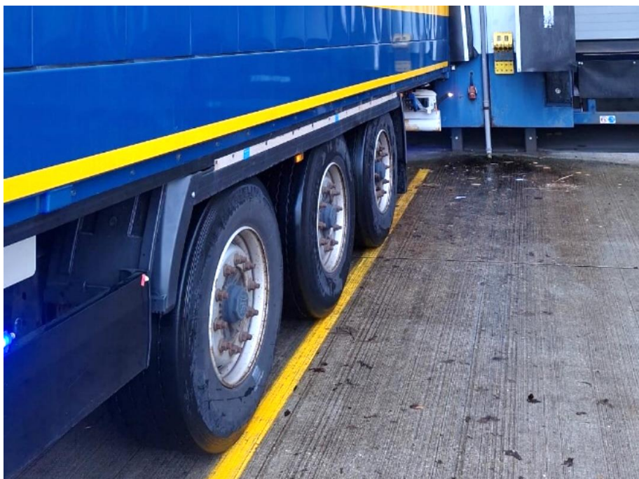
Abbildung 44: Erfolgreicher Endzustand beim Andocken eines Trailers an eine Rampe
