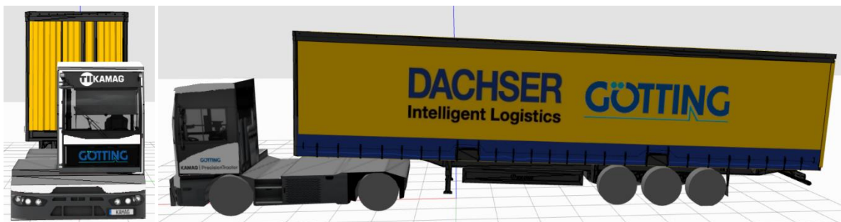
Abbildung 24: Fahrzeugmodell des Kamag PT mit Anhänger
