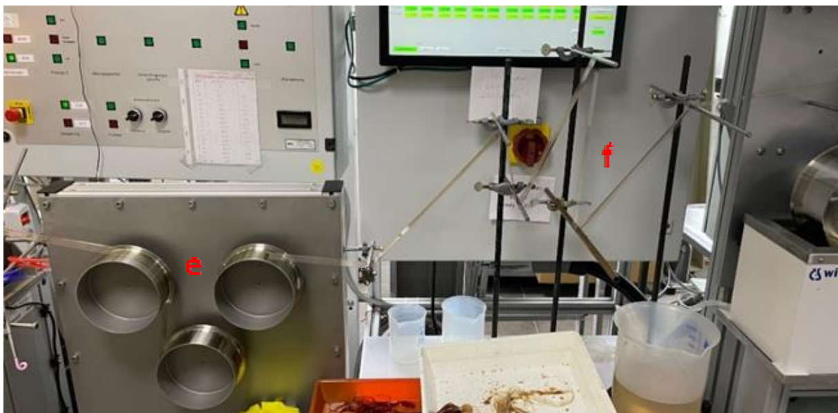
Abbildung 2: Equipment für die kontinuierliche Herstellung von Lyocellfolien mit (a) beheiztem Lösungsbehälter, (b) beheizter Spinnpumpe, (c) beheiztem Düsenpaket, (d) gekühltem Fällbad, (e) Abzugseinheit und (f) improvisierter Kaskadenmimik zum Erhalt der Folienspannung zwischen Abzugs- und Wascheinheit
