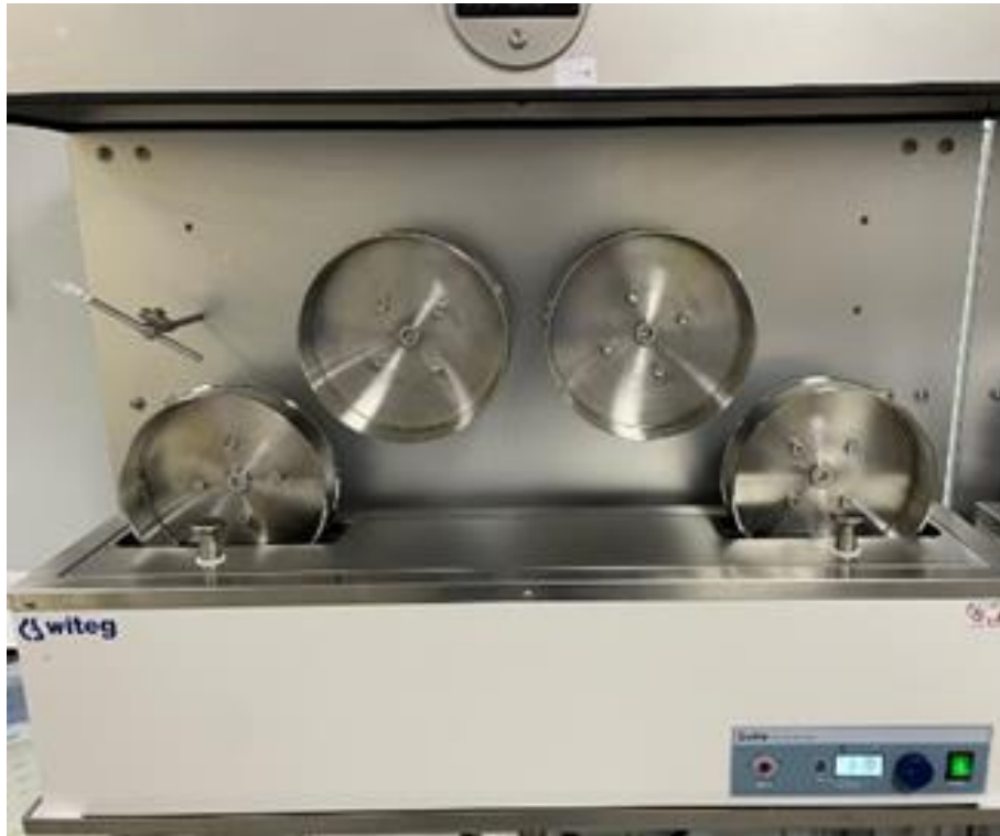
Abbildung 3: Eines von fünf Waschmodulen der Nassstrecke mit verbreiterten Galetten für den Folien-transport
