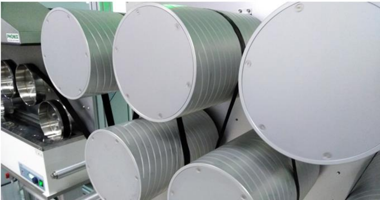
Abbildung 5: Herstellung leitfähiger, mit Ruß gefüllter Folien. Oben: Spannungsmimik zwischen Fällbad und Waschbädern. Mitte: Waschbäder und Folienführung. Unten: Umschlingung der Folien auf Heizgaletten
