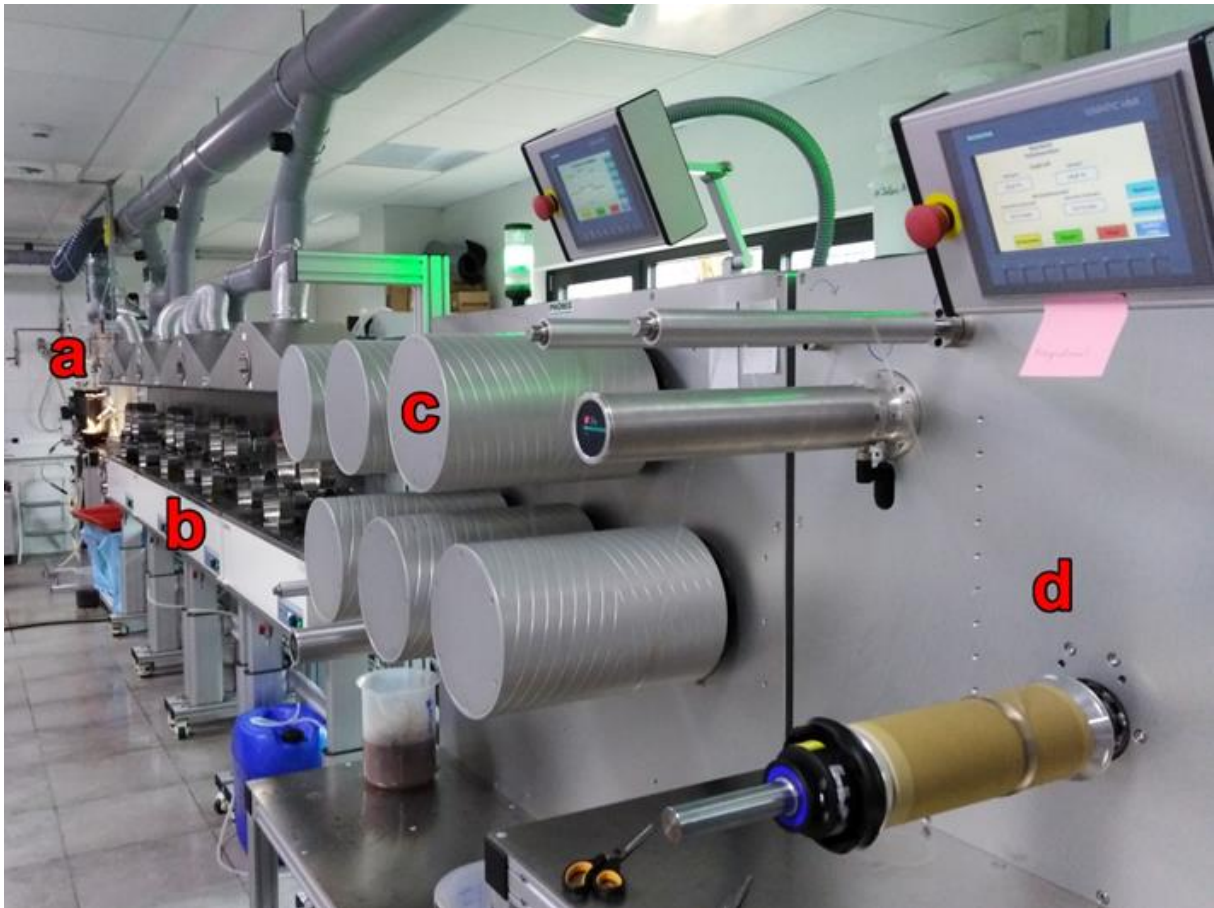
Abbildung 4: komplettierte Laborlinie mit (a) Lösungsbehälter, Pumpe und Fällbad, (b) Waschbädern und Glycerinbad, (c) Trocknermodul und (d) Wicklermodul
