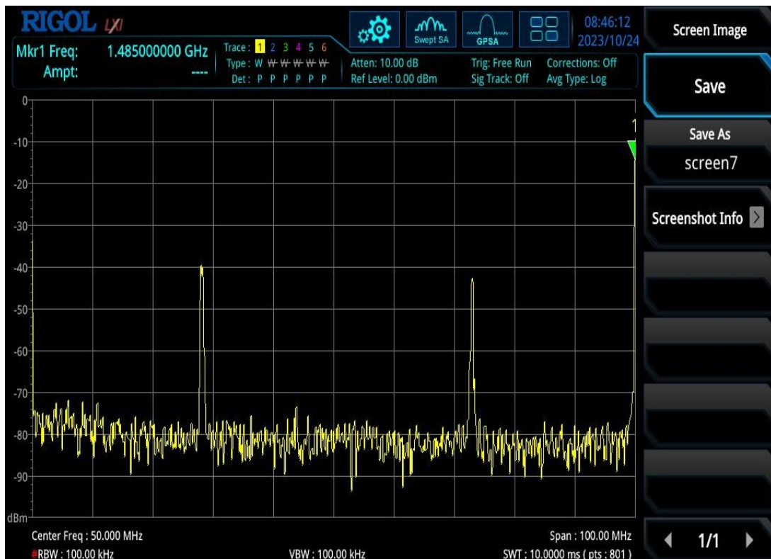
Abbildung 6: Heterodynes Schwebungssignal zu einem CW Laser bei 778 nm.
