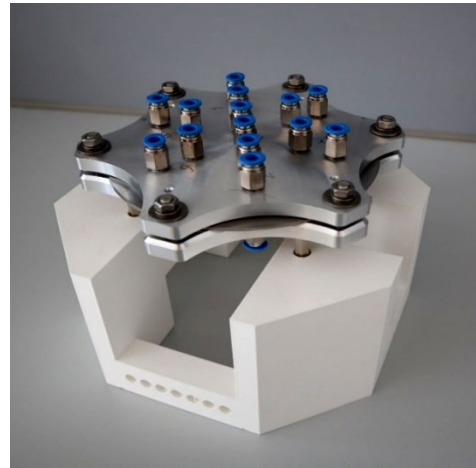
Abbildung 2: Permeationskammer mit sieben Einzelkammern zur parallel Messung mehreren Bereichen: Explosionsdarstellung Messkammer aus CAD Modell (links), und Bild nach der Fertigung (rechts)
