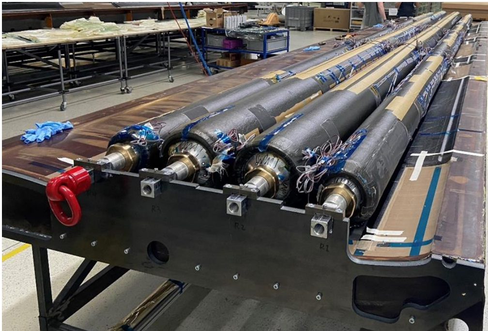
Abbildung 23: Tankröhre auf die UFS geklebt
