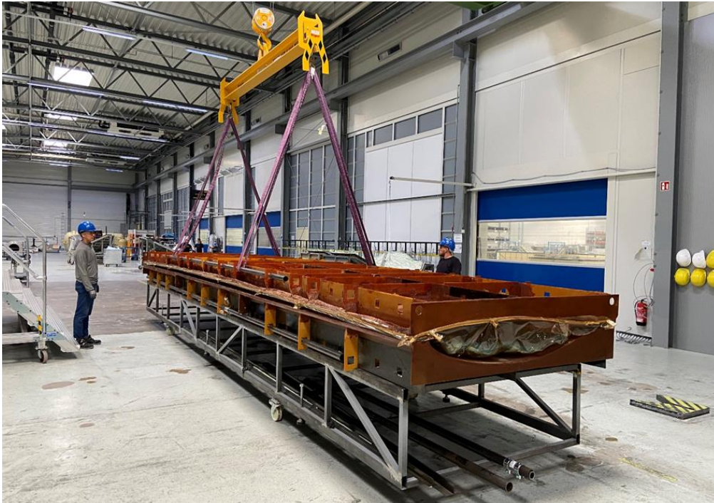
Abbildung 13: Nachhärtung der UFS- und OFS-Formwerkzeuge
