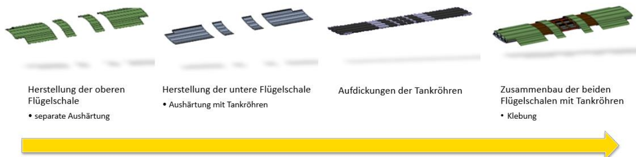
Abbildung 5: Bauweise im differentiellen Konzept
