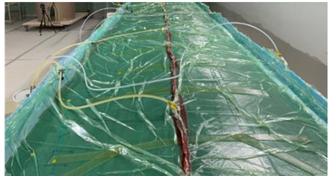
Abbildung 11: Infusion von OFS & UFS Formwerkzeug
