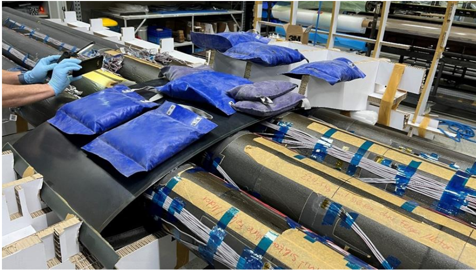
Abbildung 24: Verklebung der OFS
