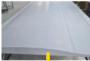
Einteiliges Formwerkzeug UFS (Material: ebaboard EP 138)
