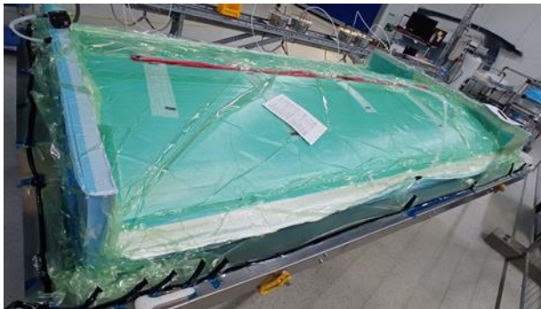
Abbildung 11: Infusion von OFS & UFS Formwerkzeug
