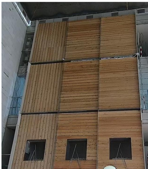
Abbildung 19: Versuchsaufbau der Großversuche am Zentrum für Brandschutzforschung. Links: Foto mit Blickrichtung auf die Fassade, rechts ein Modell mit Holzkippen und Blickrichtung auf die Außenwandbauteile, von Innen; im Bild oben rechts ist das Fenster schemenhaft zu erkennen) .
