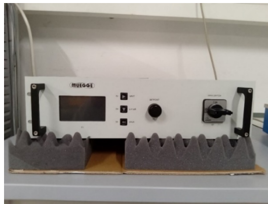
Abbildung 10: Stromversorgung und Steuereinheit für den Plasma-Membran-Teststand
