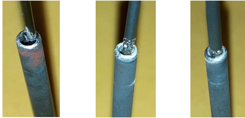
Abbildung 18: Einfluss unterschiedlicher Spaltbreiten zwischen LCCF Hohlfaser und Edelstahlrohr auf die Dichtigkeit.
