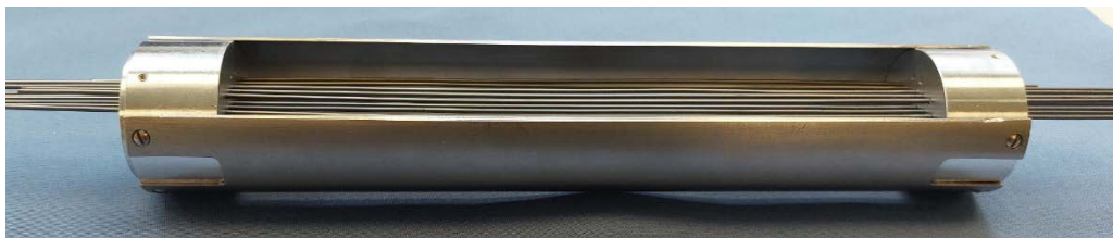
Abbildung 20: Mehrfasermodul mit Stützleisten zum Einbau in den Plasma-Membran Reaktor.
