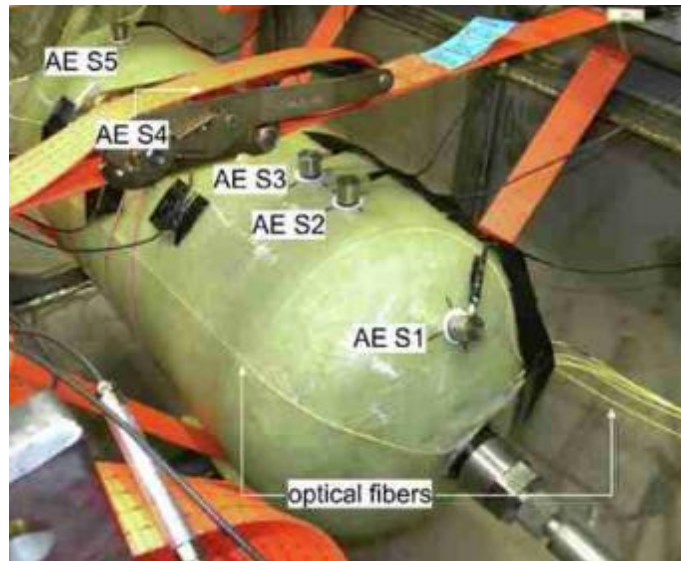
Abbildung 4. Druckbehälter aus Verbundwerkstoff mit akustischen Sensoren und optischen Fasern, der in der hydraulischen Innendruck-Zyklusmaschine eingebaut ist [5].
