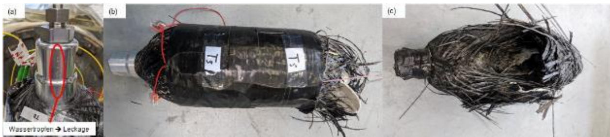
Abbildung 35. (a) Leckage des Prüfmediums am Druckbehälterventil (b) Tankversagen am Übergang zwischen Zylinder und Dombereich (c) Tankversagen am Zylinder.
