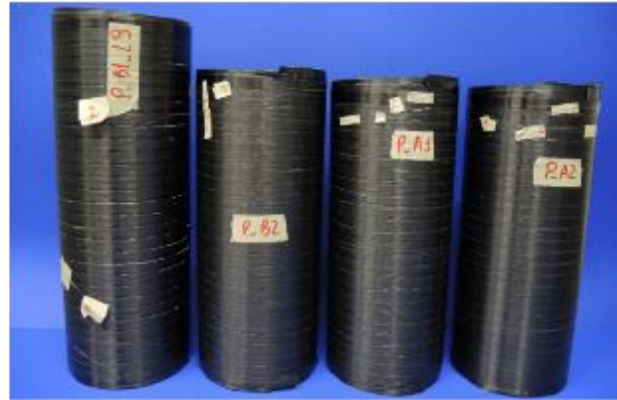
Abbildung 11: Schema des laserunterstützten Tapewickels (links) und hergestellte Rohrkörper mit integrierter Sensorfaser (rechts).
