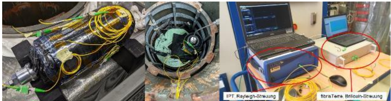
Abbildung 33. Versuchsaufbau zur Durchführung von hydraulischen Berstversuchen an instrumentierten Druckbehältern bei gleichzeitiger Dehnungsmessung.
