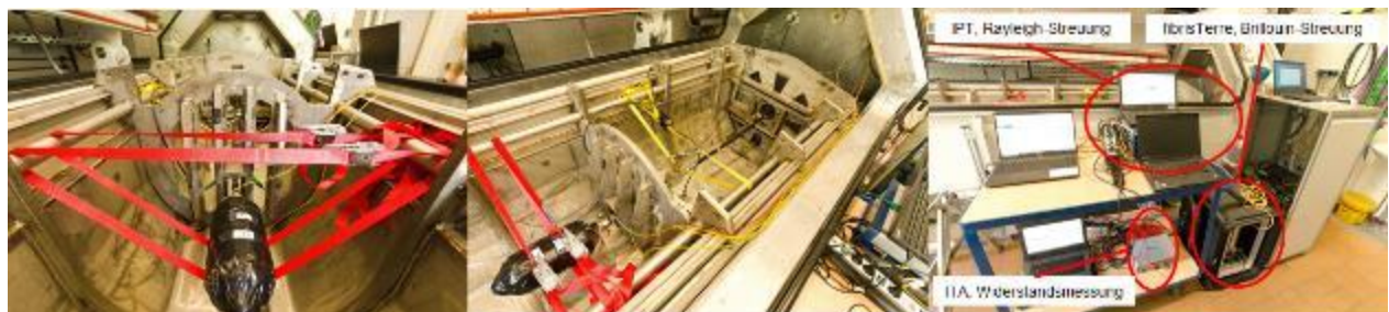
Abbildung 34. Versuchsaufbau zur Durchführung von hydraulischen Lastwechselfersuchen an instrumentierten Druckbehältern bei gleichzeitiger Dehnungsüberwachung.
