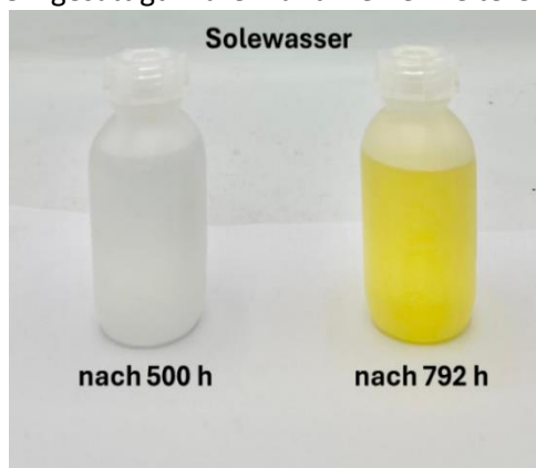
Abbildung 14: Farbänderung der Solewasserprobe nach 792 Stunden im Vergleich zur Probe nach 500 Stunden
