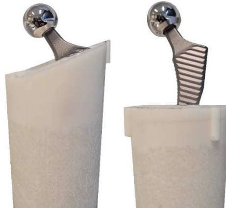
Abbildung 7: In Polyurethan fixierte Hüftschäfte zur Prüfung der Dauerfestigkeit nach ISO 7206-6 (links) und ISO 7206-4 (rechts)
