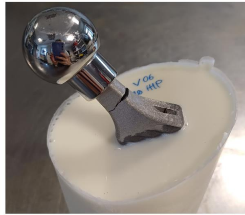
Abbildung 9: Beispiele für Halsbrüche während der Testung nach ISO 7206-6.
