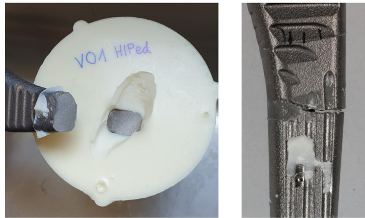
Abbildung 11: Beispiele für Schaftbrüche während der Testung nach ISO 7206-4.
