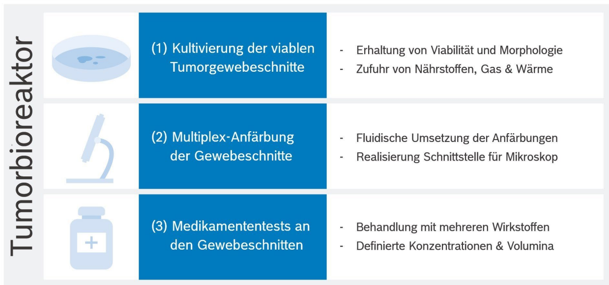
Abbildung 1: Entwicklung eines Tumorbioraktors im Teilvorhaben der Robert Bosch GmbH zur Umsetzung der drei Hauptfunktionen: Kultivierung, Multiplex-Anfärbung und Medikamentenbehandlung von viablen Tumorgewebeschnitten.
