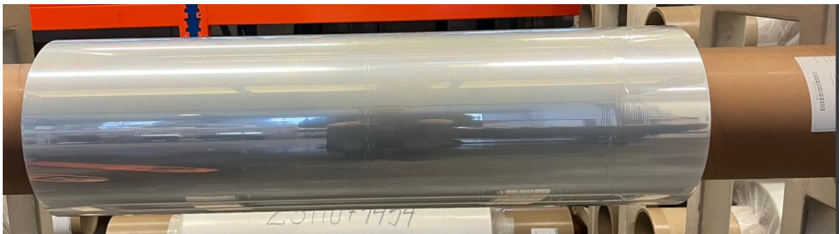
Abbildung 5: Mit optimierten Wickelparametern gewickelte Musterrolle (Okt 2023).
