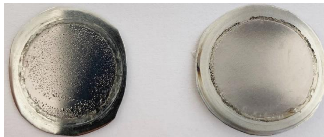
Abb. 6: Einfluss eines Nickel-Strikes auf die Beständigkeit galvanischer Schichten unter anodischen Belastungen, wie sie bei der PEM-Elektrolyse auftreten. Links Ni-Strike-Abscheidung mit nicht-optimierten Prozessparametern; rechts Ni-Strike-Abscheidung mit optimierten Parametern.
