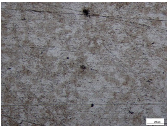
Abbildung 5: Mikroskopische Betrachtung der Gefügestruktur des stranggepressten Stabs mit besonderem Fokus auf eventuelle Fehlstellen.
