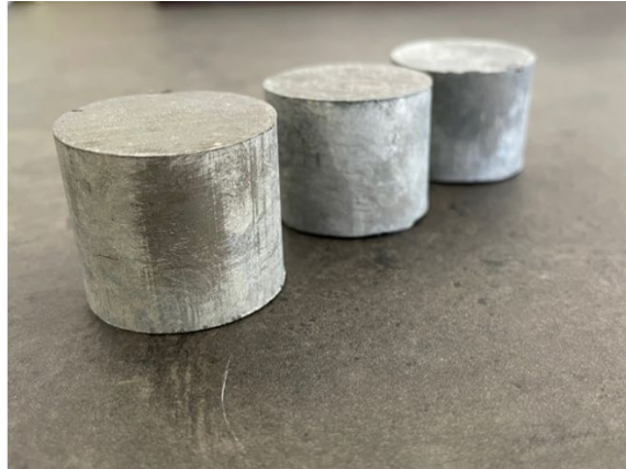
Abbildung 3: Makroskopische Begutachtung der Gussstäbe der Vorlegierung (links) und der Ziellegierung (rechts, welche zur weiteren Verarbeitung bereits in mehrere kleine Blöcke geschnitten wurde) hinsichtlich Fehlstellen.
