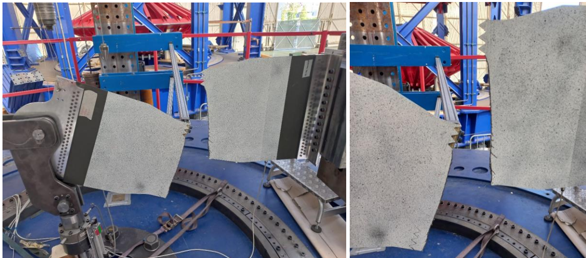
Abbildung 34: Zugbelastetes Panel nach Bruch
