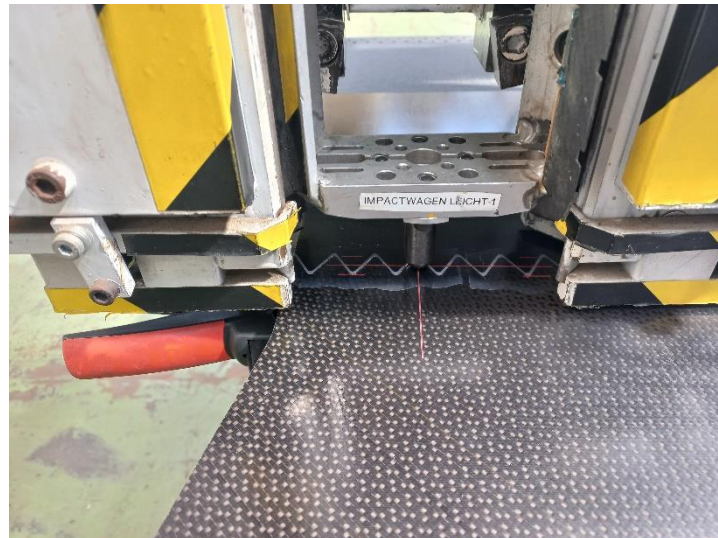
Abbildung 30: Erzeugung des Impact-Schadens im Fallturm
