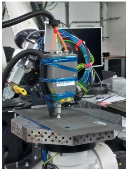
Abbildung 25: Atmosphären-Druck-Plasma-Behandlung der Klebeflächen
