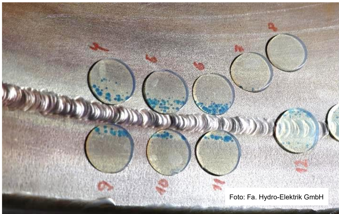
Abbildung 6: KorroPad®-Prüfung an einer Schweißnaht mit deutlichen Anzeigen einer instabilen Passivschicht im Bereich der Wärmeinflusszone durch unzureichende Nacharbeit
