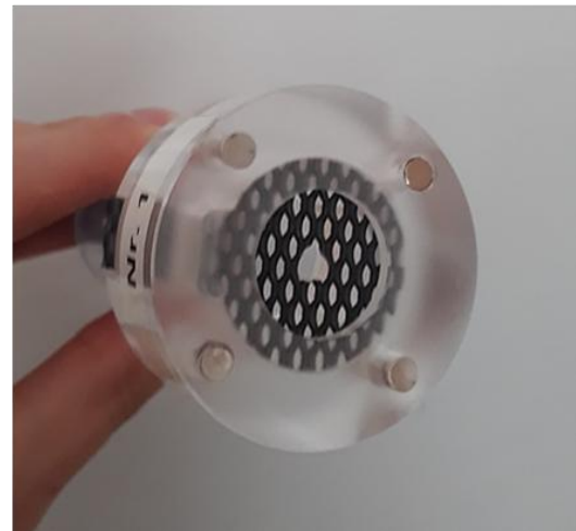
Abbildung 3: links: Praktische Anwendung des Prüfverfahrens DIN 50023 an einer Leitplanke, rechts: Ansicht Unterseite des Prüfkopfes mit Dauermagneten (außen) und Gegenelektrode (zentral)
