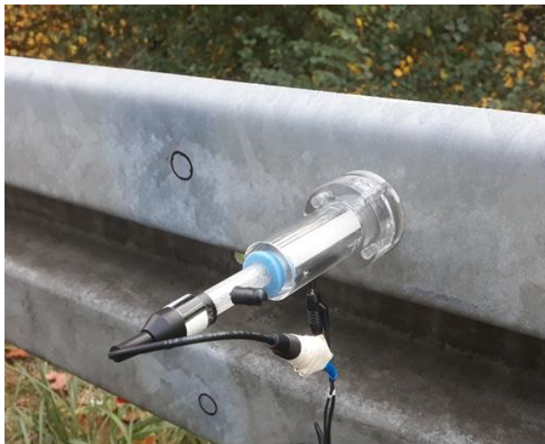
Abbildung 3: links: Praktische Anwendung des Prüfverfahrens DIN 50023 an einer Leitplanke, rechts: Ansicht Unterseite des Prüfkopfes mit Dauermagneten (außen) und Gegenelektrode (zentral)
