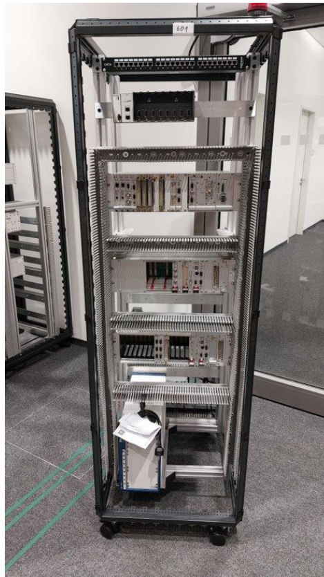
Abbildung 44 Aufbau Teststand Phase 2 - unverdrahtet
